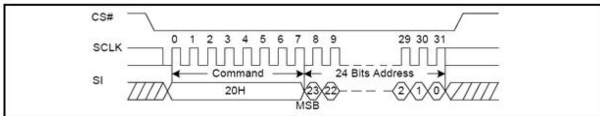
注：擦除指令发送 CS#变高后需进行忙状态判断，等待芯片内部完成擦除后，才可以对芯片进行下一步操作，判断忙状态请参考该型号相应的库文件，如无库文件请与我司索要。
