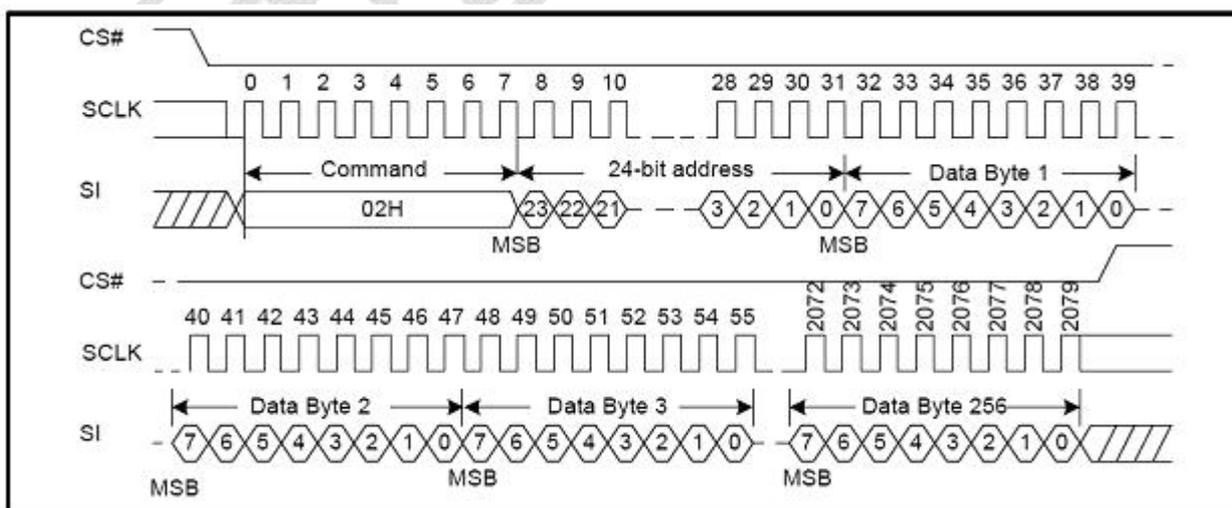
注：写入指令发送 CS#变高后需进行忙状态判断，等待芯片内部完成写入后，才可以对芯片进行下一步操作，判断忙状态请参考该型号相应的库文件，如无库文件请与我司索要。
