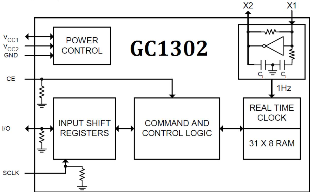
图 1 显示了串行计时器的主要元素：移位寄存器，控制逻辑，振荡器，实时时钟，还有 RAM。
