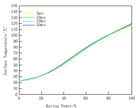
备注：表面温度测板采用铝基板
