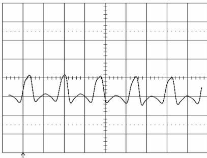
Output voltage ripple (20mV/div.) at:
