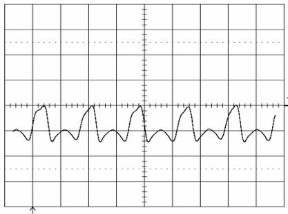
Output voltage ripple (20mV/div.) at:
