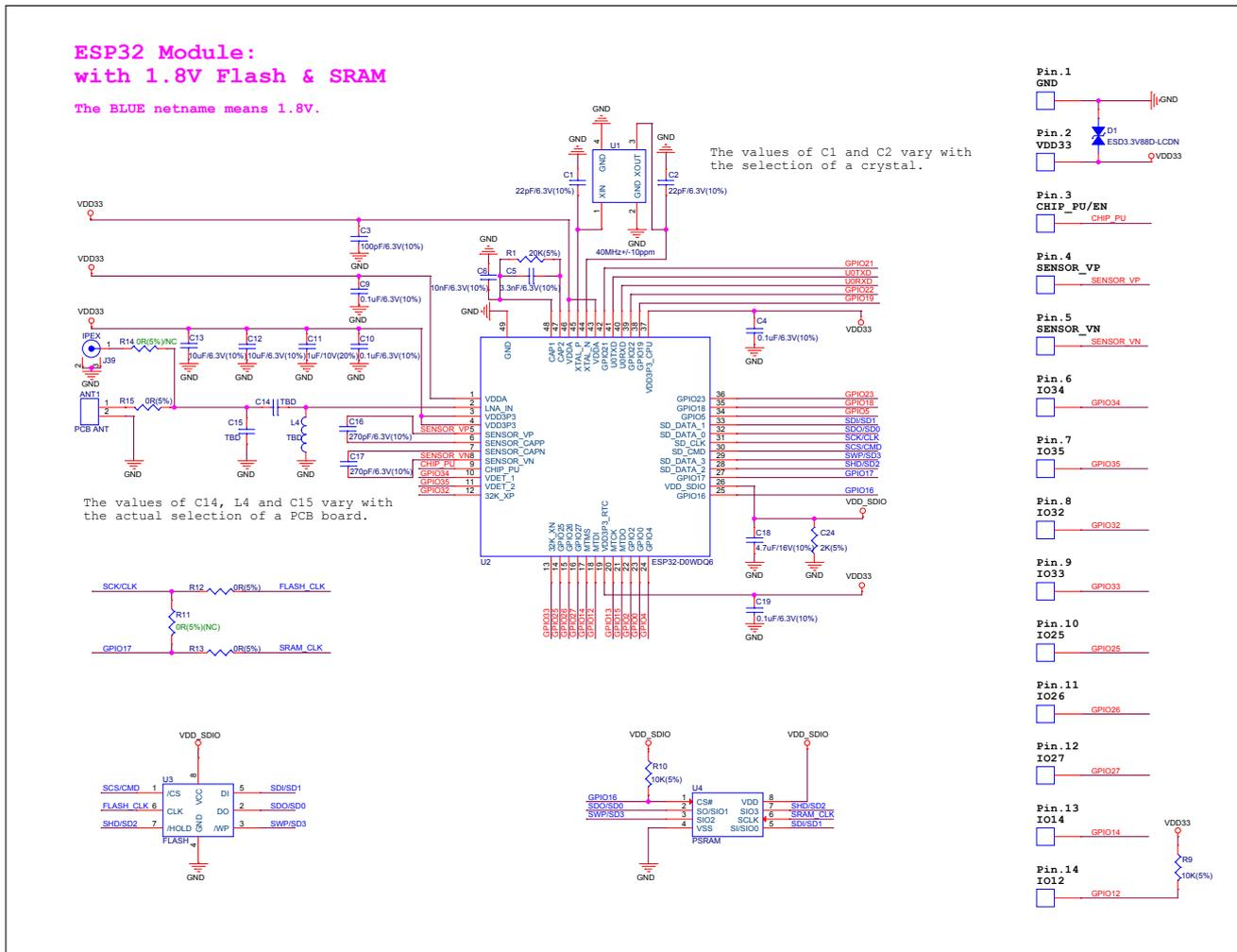
图 3: ESP32-WROVER 电路原理图
