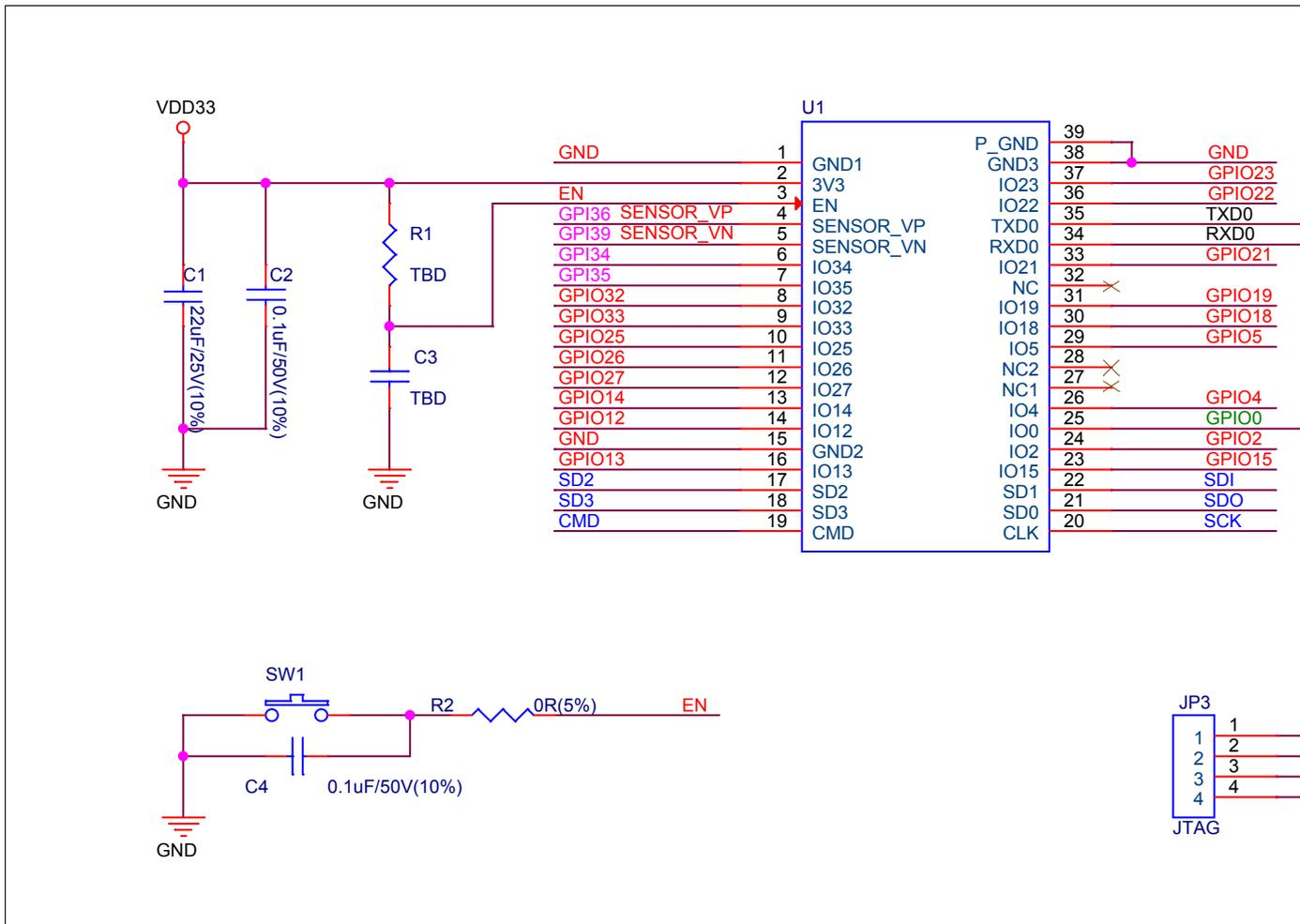
图 4: ESP32-WROVER 外围原理图
