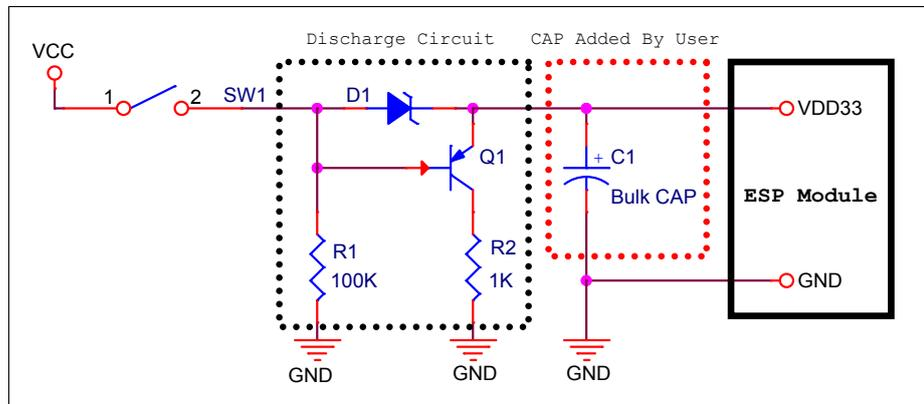
**图 5: VDD33 放电电路图****说明:**
