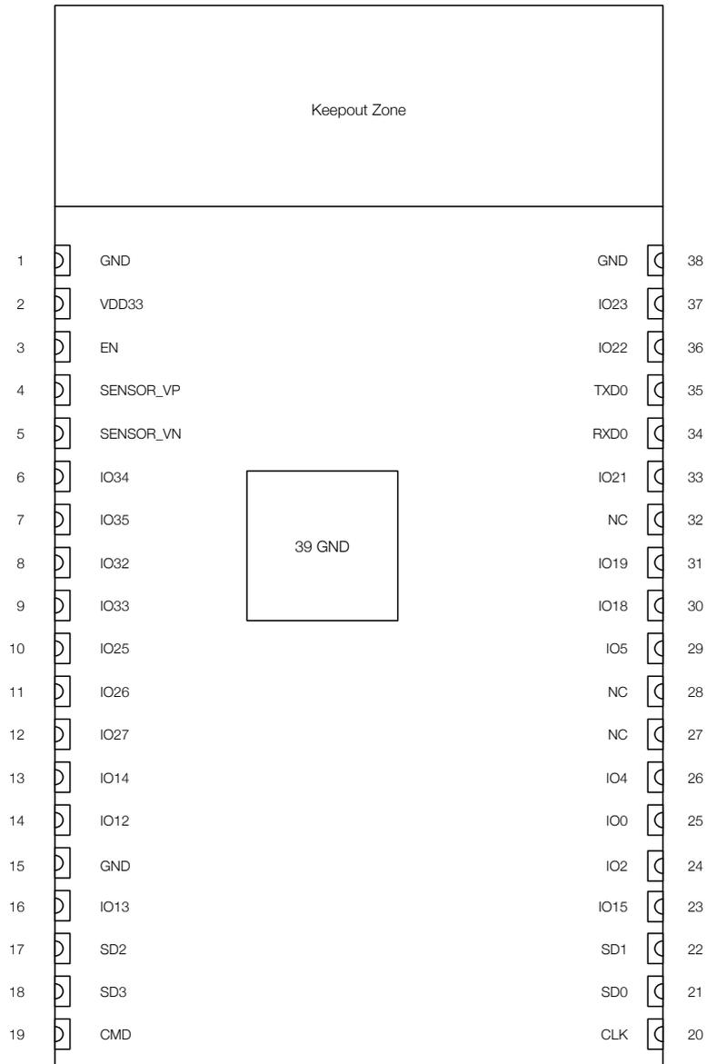
图 1: ESP32-WROVER 管脚布局 (顶视图)
