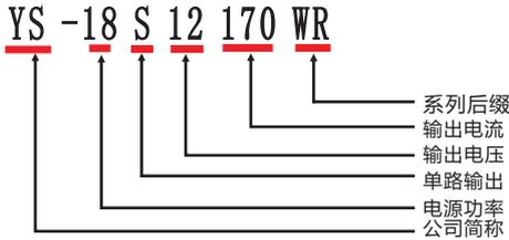
YS-18SWR系列是高可靠性,输出高达20W基板插针式单路输出电源,适合输入电压90~265VAC应用,可根据客户需求设定不同电压,可适应多种消费类电子设备需求.
