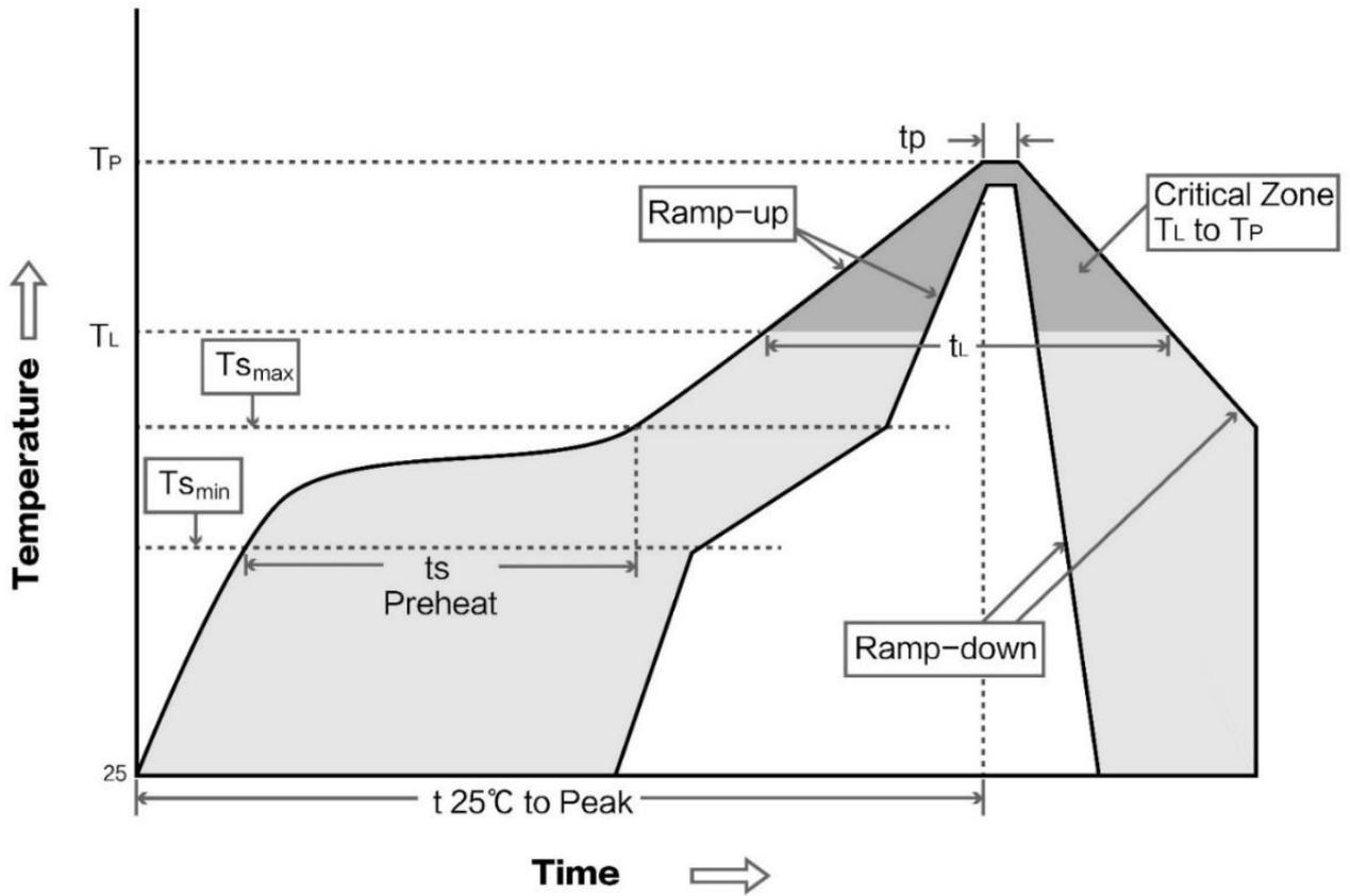
图表 十一- 2 回流焊曲线图
