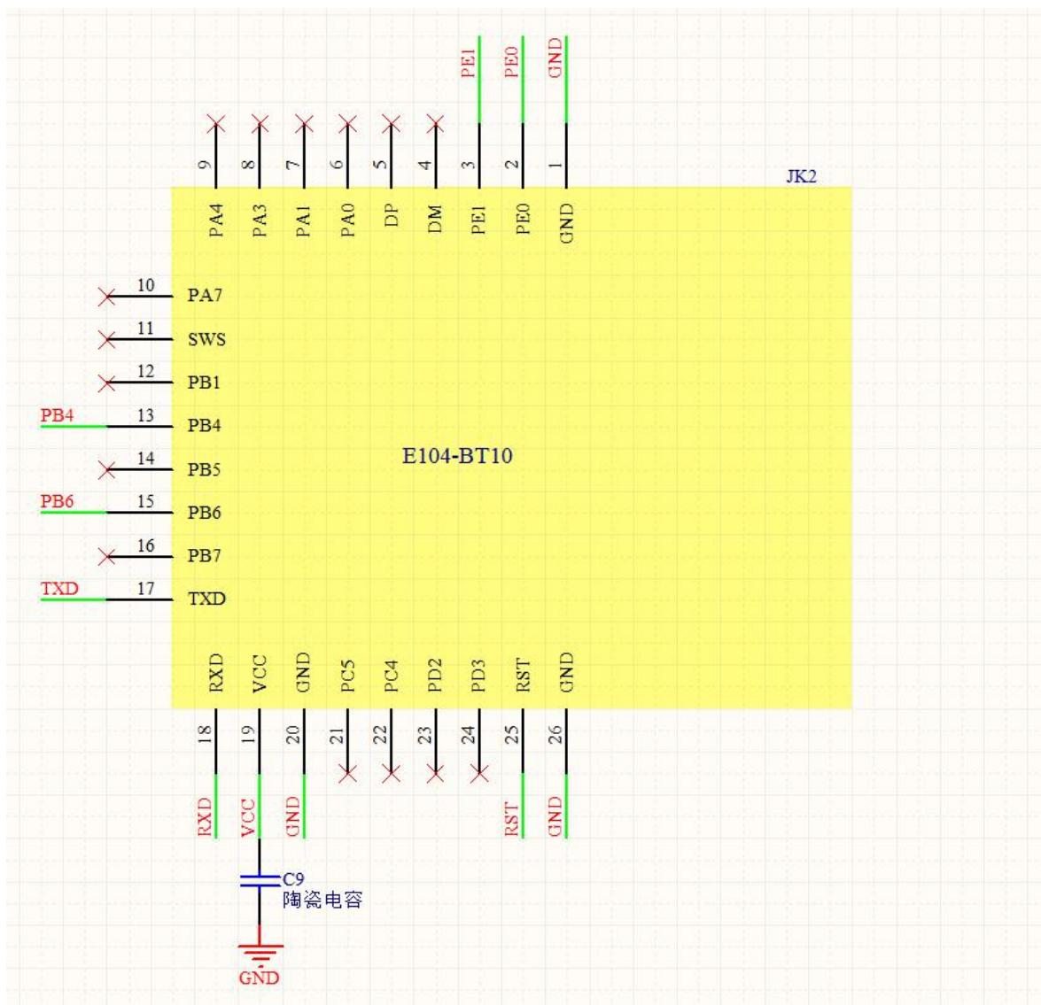
如图所示，模块只需将 VCC, GND, TX, RX 接出即可进行通讯测试。
