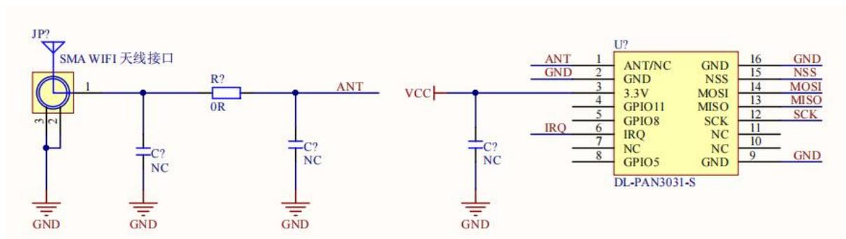
说明:上图为最小通信连接线路,四线 SPI、IRQ 管脚都需要连接到单片机 IO 口
