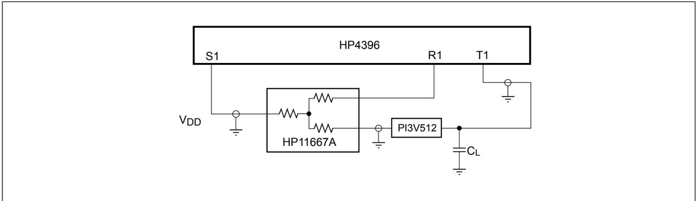
**Off Isolation** ( $V_{DD}$  3.3V, 25°C)
