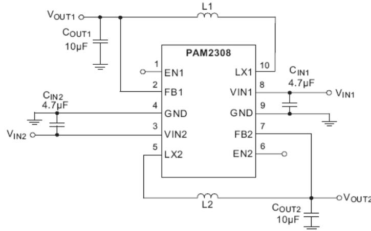
$$V_{OUTx} = 1.2V, 1.5V, 1.8V, 2.5V, 2.8V \text{ or } 3.3V$$
