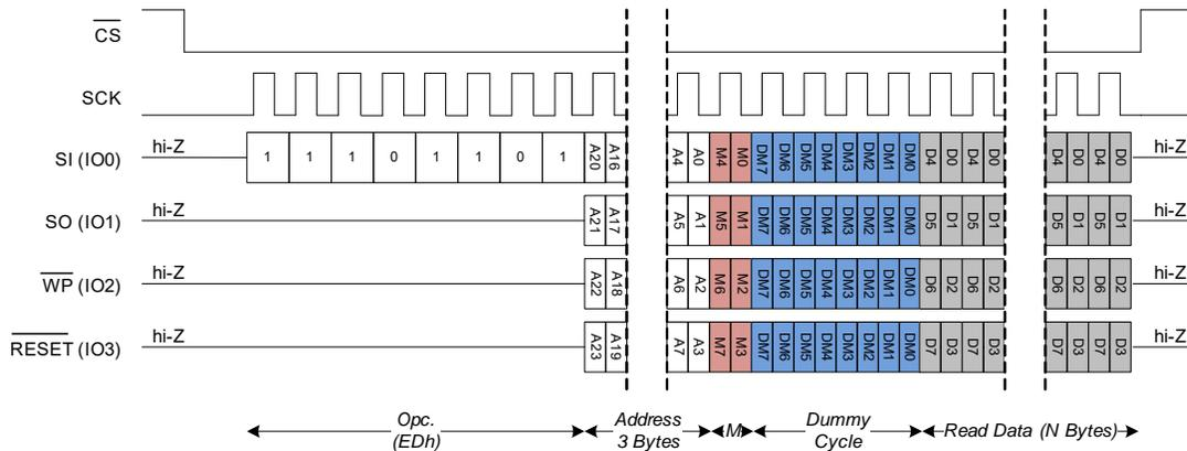
**DDR Quad I/O Read (DDRQIOR EDh) – In QPI Mode**
