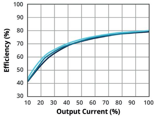
**EFFICIENCY VS OUTPUT LOAD**
