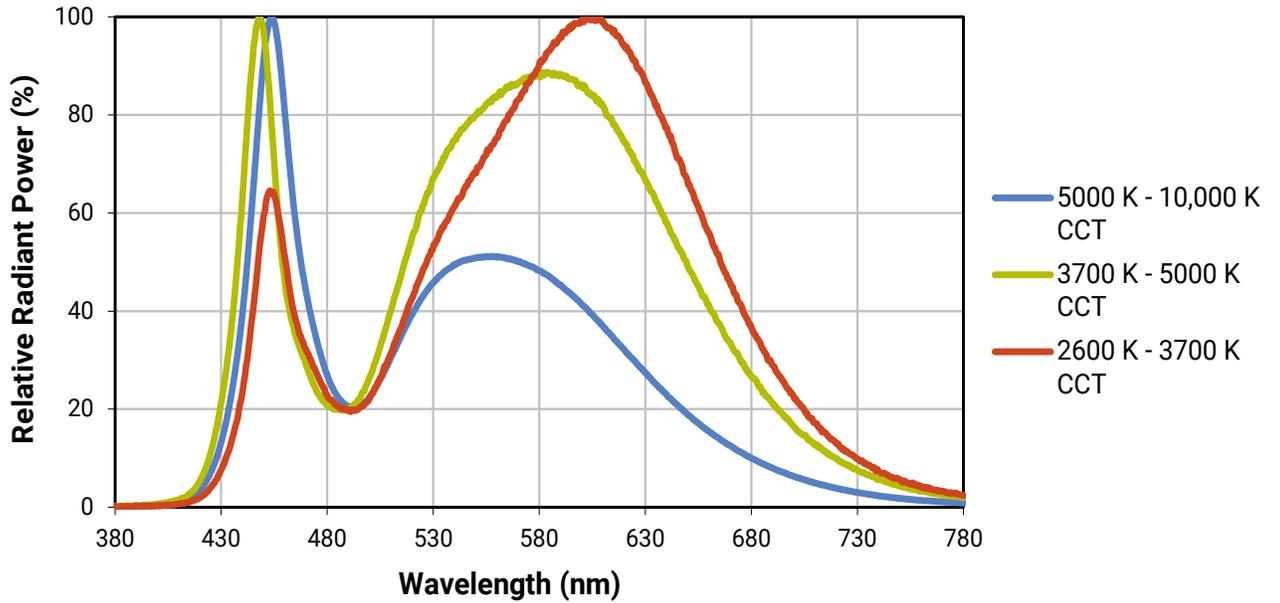
**RELATIVE SPECTRAL POWER DISTRIBUTION ( $I_F = 350$  mA PER LED) - COLOR**
