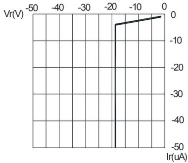
FIG.3 BLUE&GREEN REVERSE CURRENT VS. REVERSE VOLTAGE.
