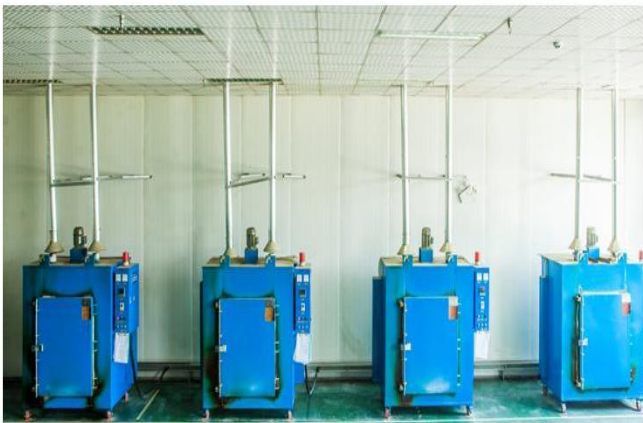
工厂车间图：箱式排胶车间
