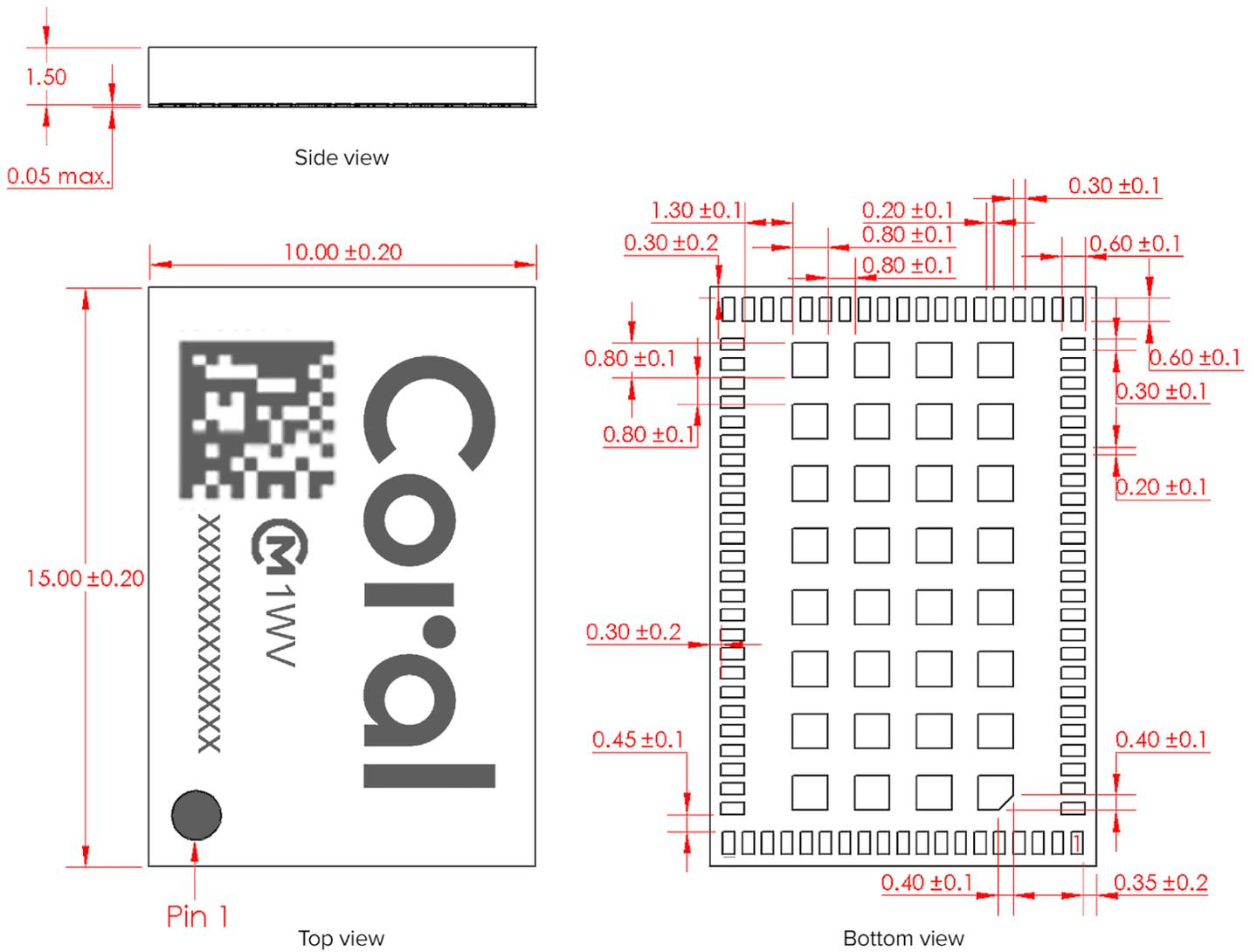
Figure 8. Module dimensions
