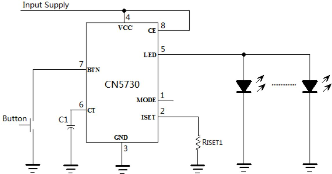
图 5 CN5730 驱动并联发光二极管(LED)
