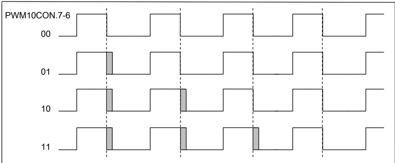
图 17-2: PWM10 占空比输出示意图
