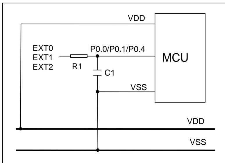
图 7-2: 外部中断 I/O 连接图
