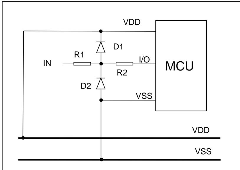
图 6-3: I/O 口注意事项连接图
