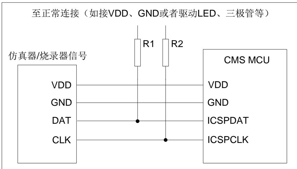
图 1-1：典型的在线串行编程连接方式
