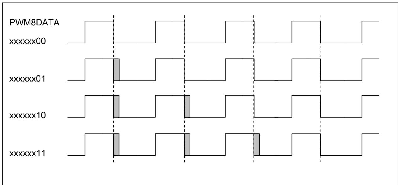
图 16-2: 6+2 模式 8 位 PWM 输出示意图
