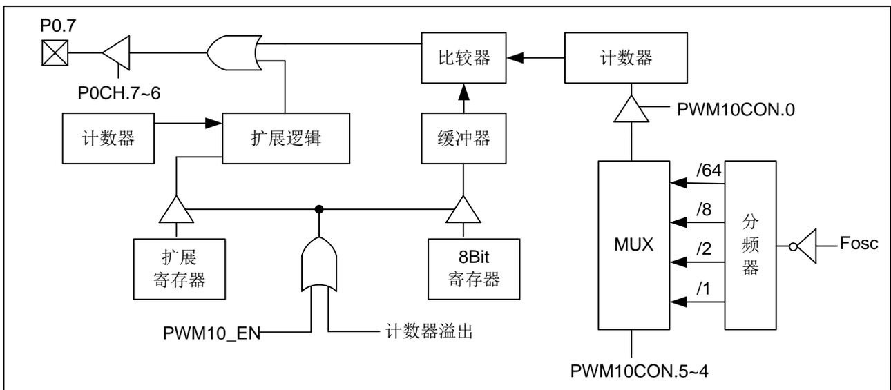
图 17-1: PWM10 结构框图
