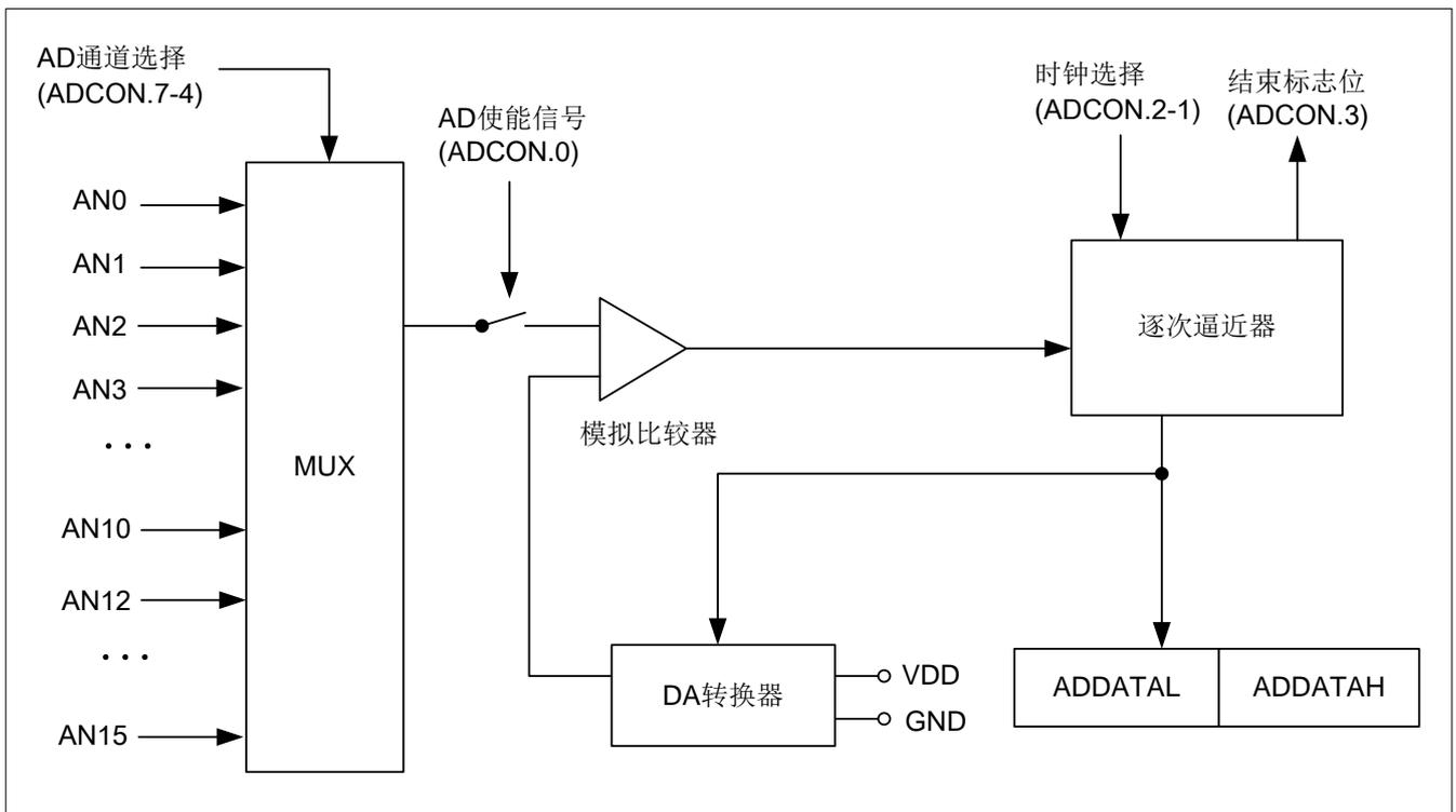
图 11-1: ADC 结构框图
