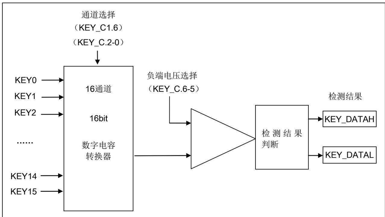
图 15-1: CMS89F61x 的内部电路框图
