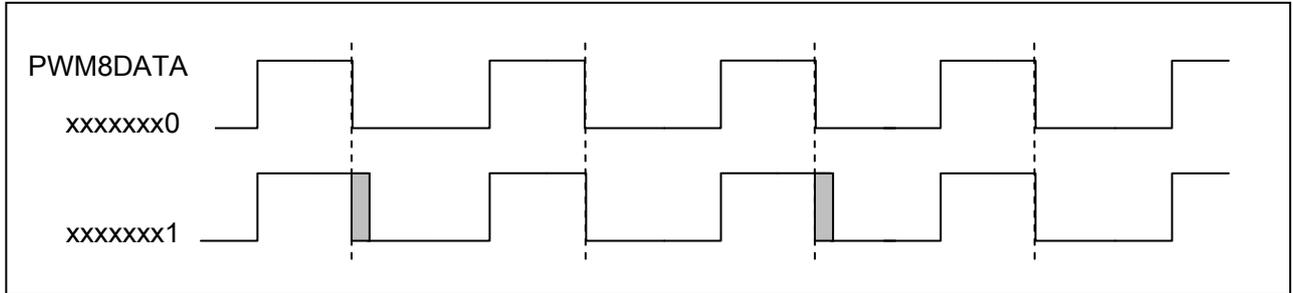
图 16-3: 7+1 模式 8 位 PWM 输出示意图
