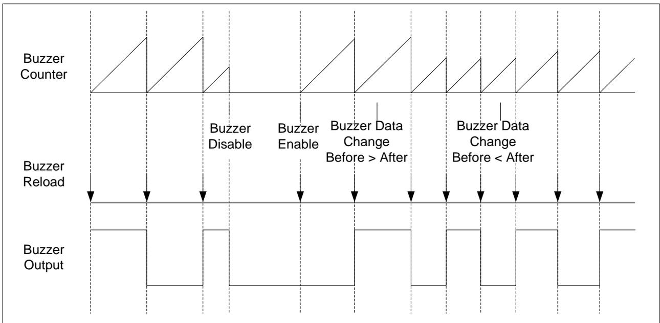
图 19-2: BUZZER 输出时序图
