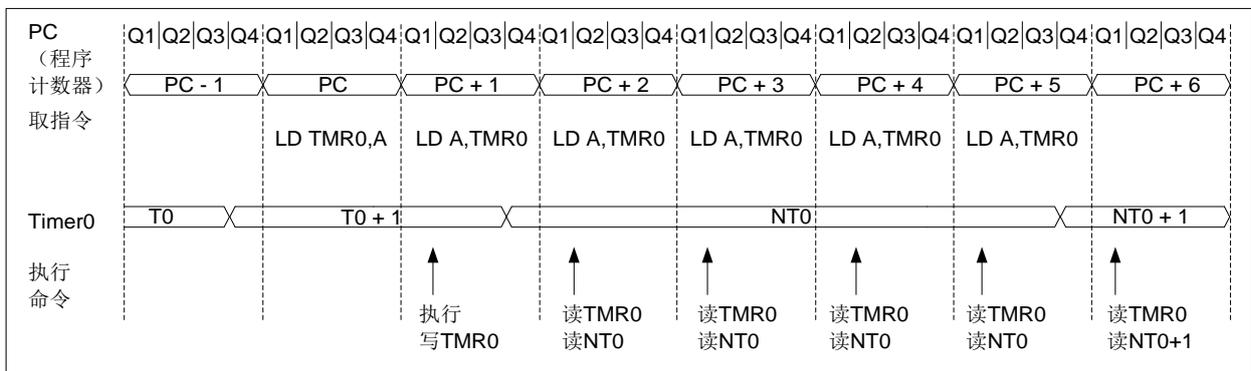
图 8-3: TMR0 时序图 (内部时钟/预分频器 1:2)
