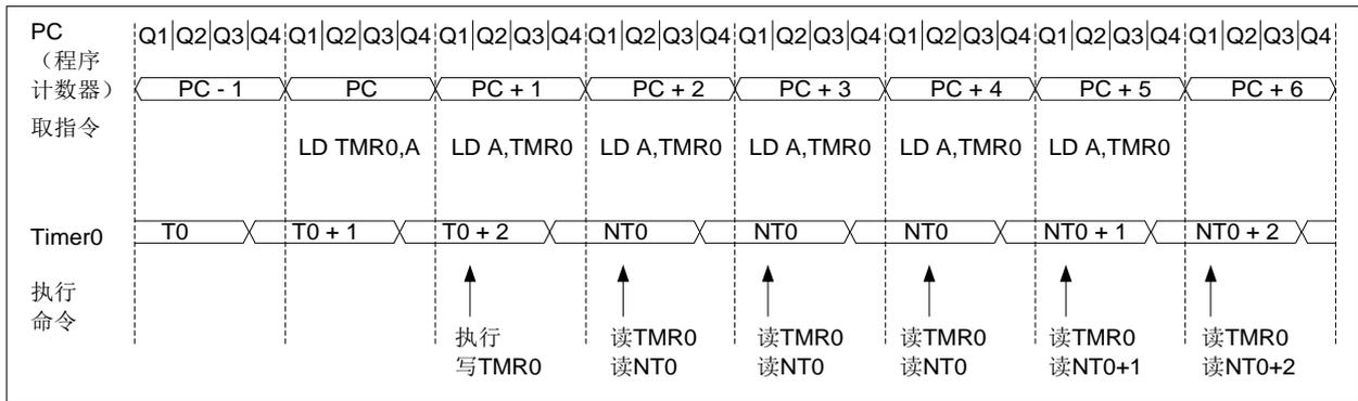
图 8-2: TMR0 时序图 (内部时钟/无预分频器)
