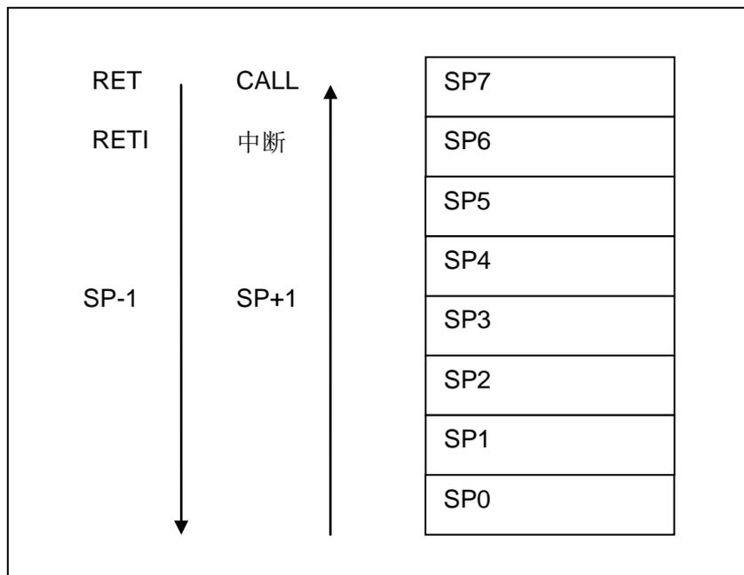
图 2-2: 堆栈缓存器工作原理
