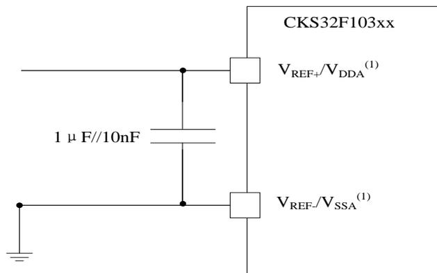
图 48 供电电源和参考电源去藕线路( $V_{REF+}$ 与  $V_{DDA}$  相连)
