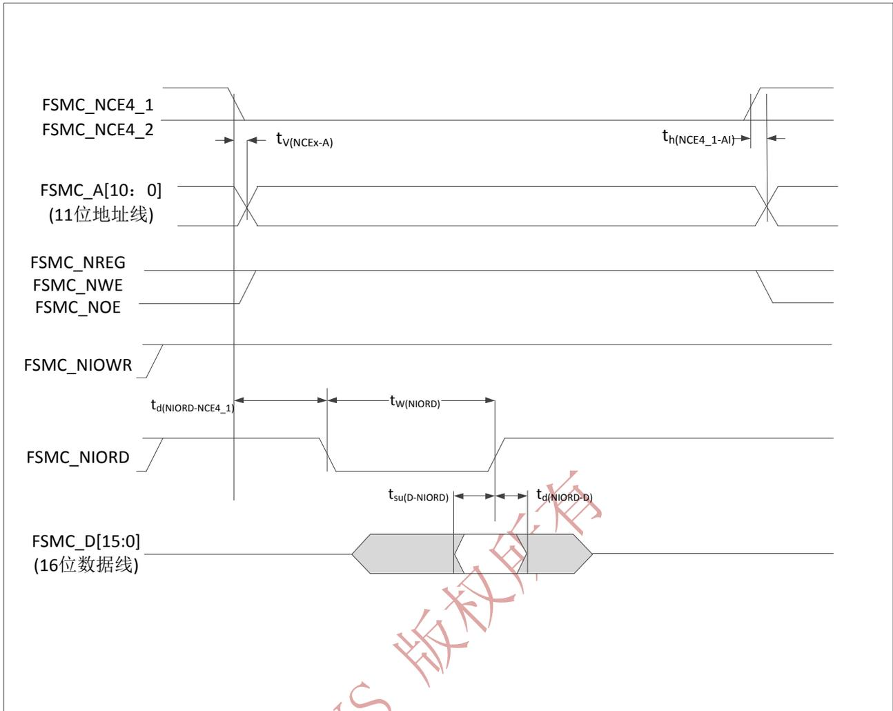
图 28 I/O 空间读操作的 PC 卡/CF 卡控制器波形
