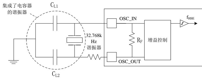
图 15 使用 32.768kHz 晶体的典型应用
