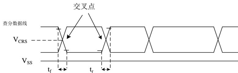
图 44 USB 时序: 数据信号上升和下降时间定义
