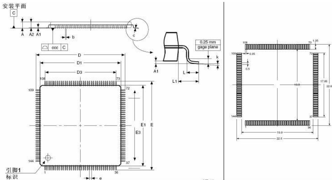
图 49 LQFP144, 20x20mm, 144 脚低剖面方形扁平封装图<sup>(1)</sup>
