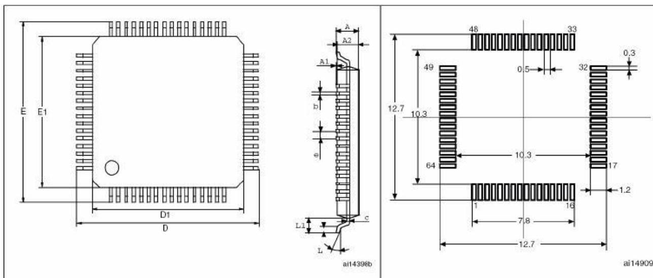
图 51 LQFP64, 64 脚低剖面方形扁平封装图
