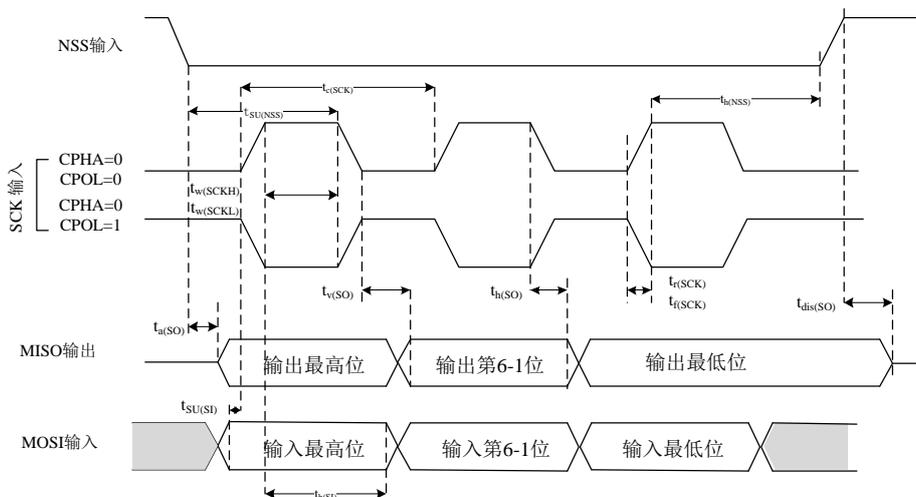
图 37 SPI 时序图-从模式和 CPHA=0
