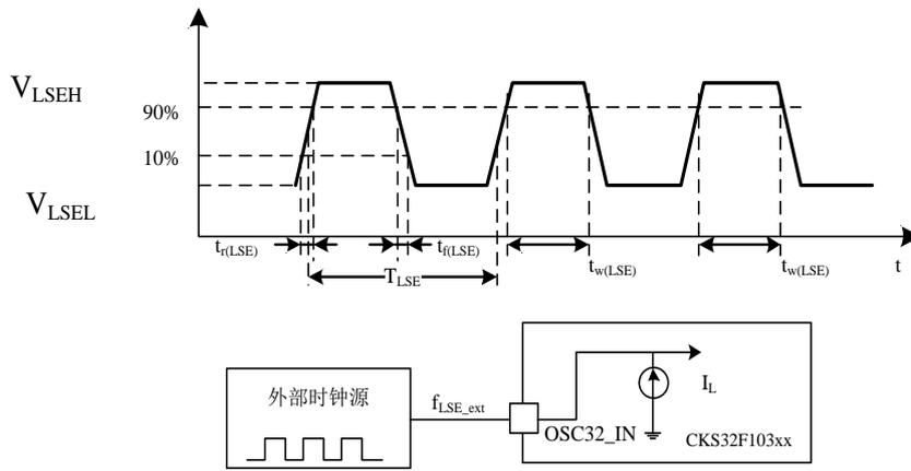
图 13 外部低速时钟源的交流时序图
