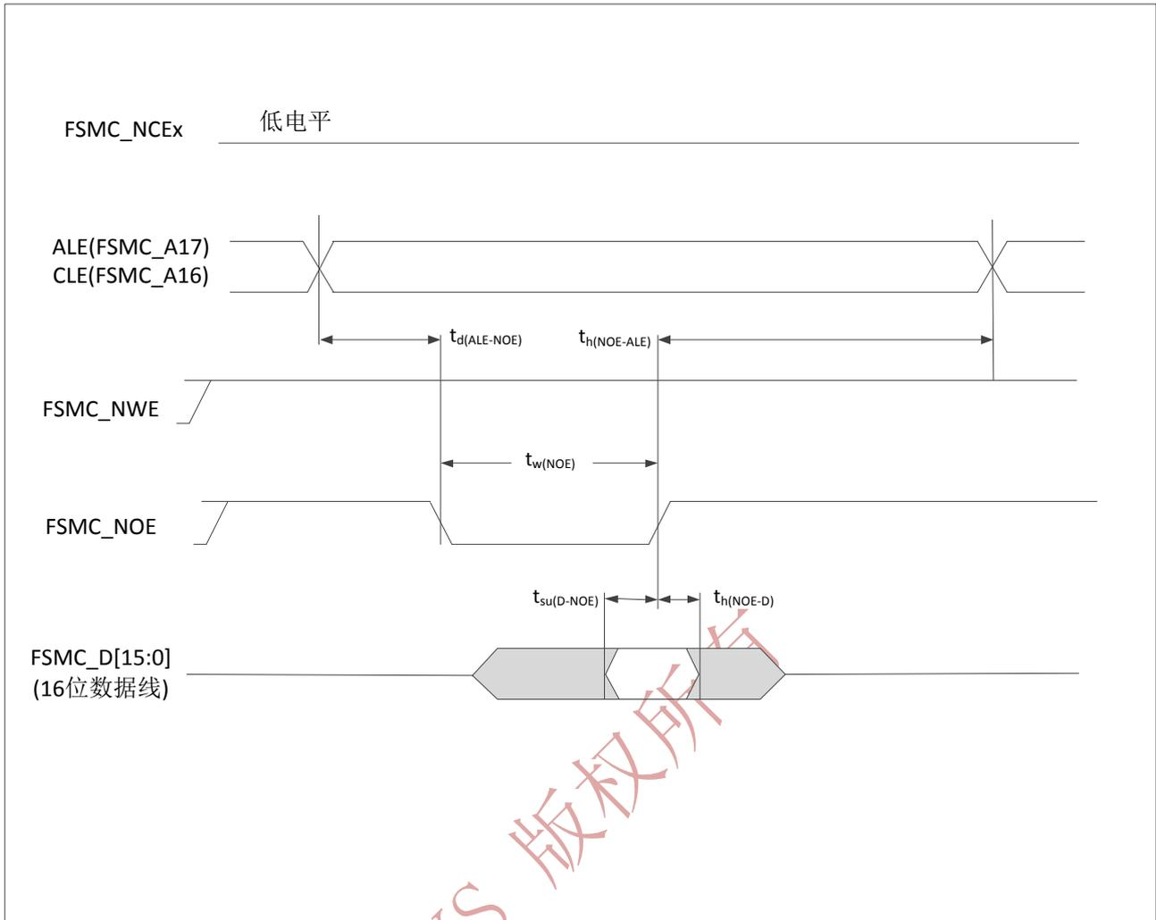
图 32 NAND 控制器在通用存储空间的读操作波形
