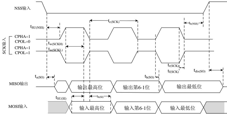
图 38 SPI 时序图- 从模式和 CPHA=1<sup>(1)</sup>
