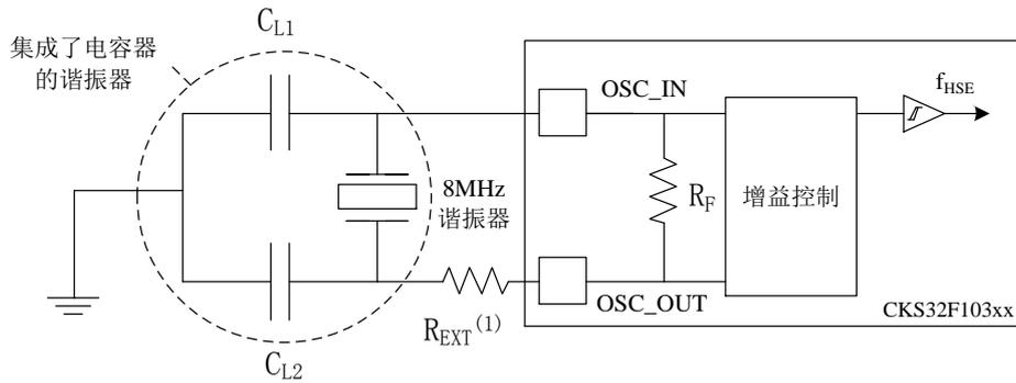
图 14 使用 8MHz 晶体的典型应用
