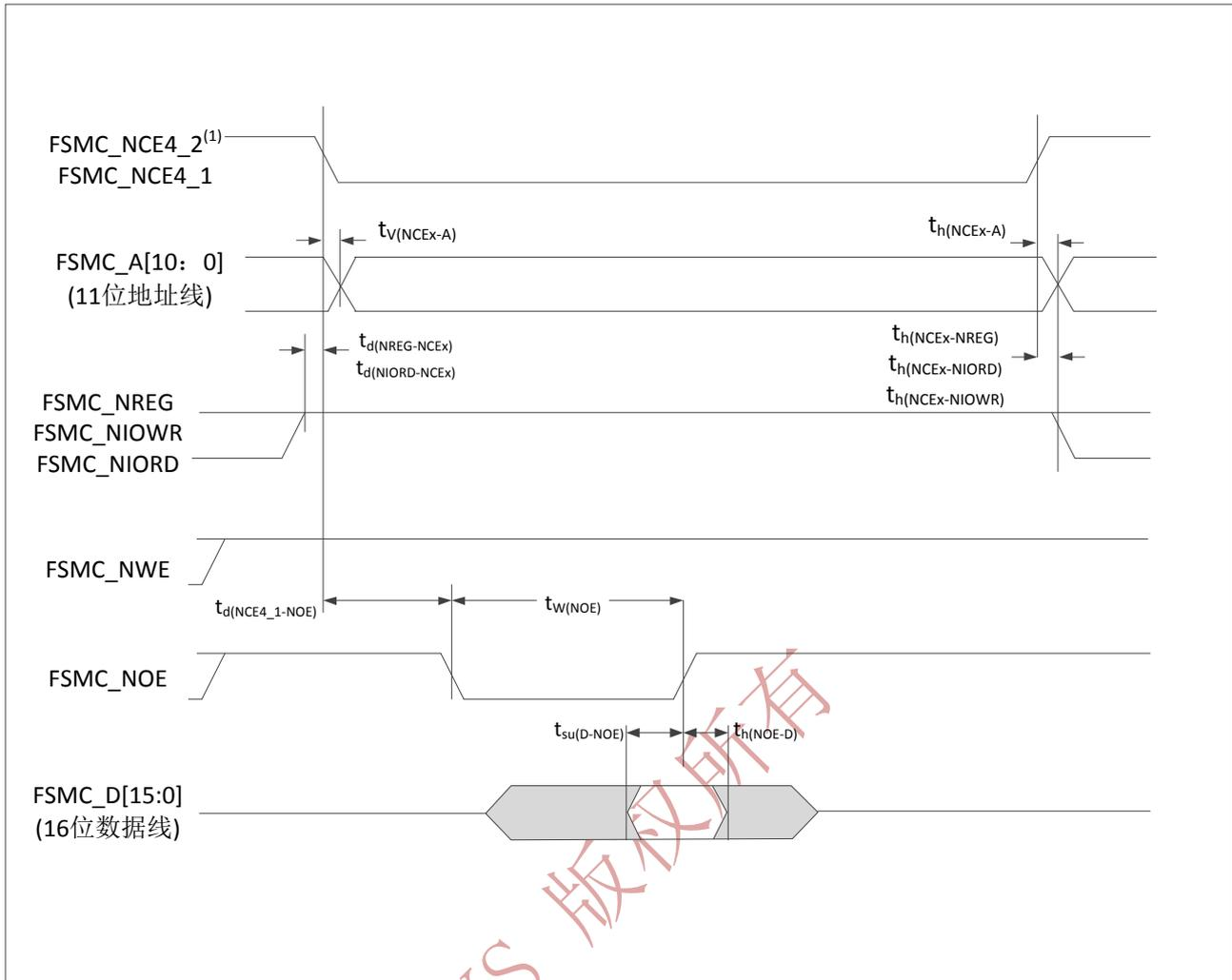
图 24 通用存储空间读操作的 PC 卡/CF 卡控制器波形
