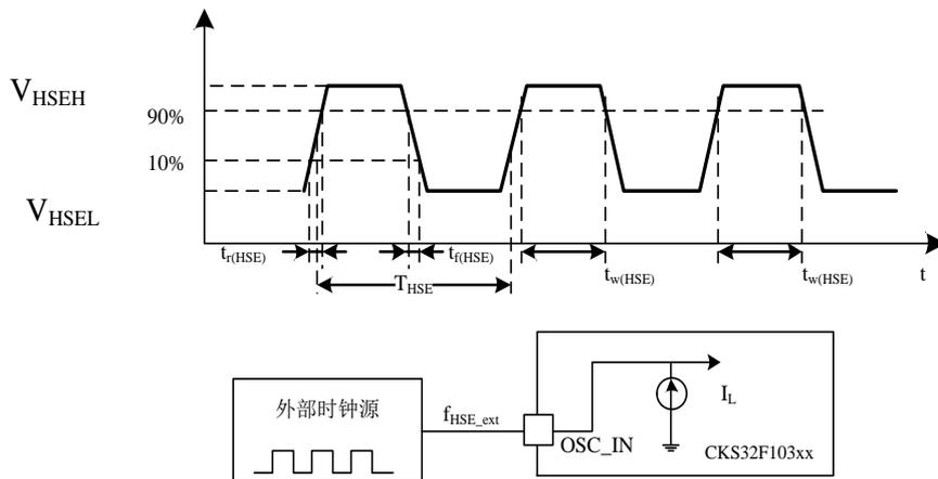
图 12 外部高速时钟源的交流时序图
