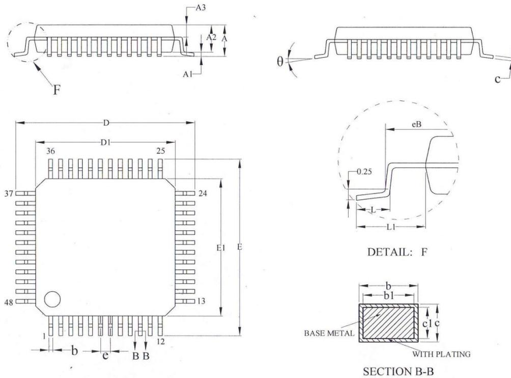
图 52 LQFP48, 48 脚低剖面方形扁平封装图
