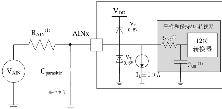
图 46 使用 ADC 典型的连接图
