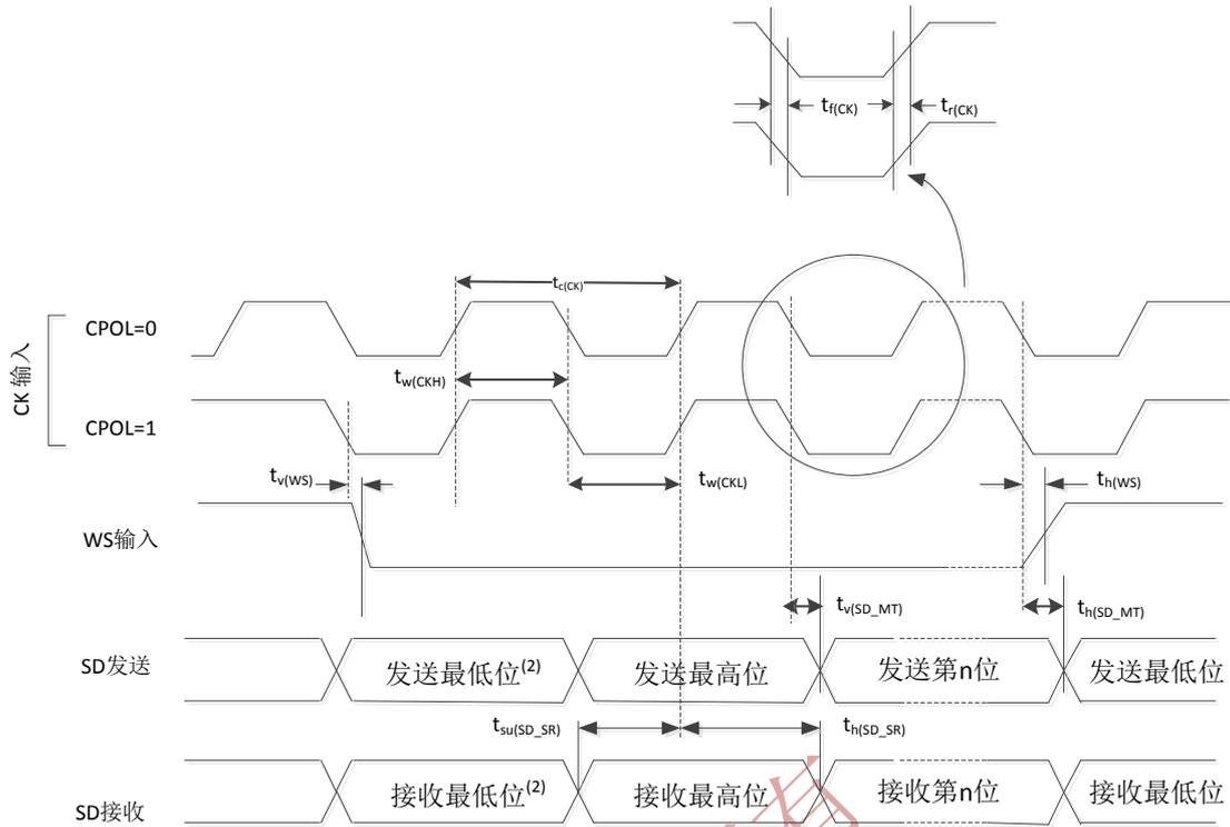
图 41 I<sup>2</sup>S 主模式时序图(飞利浦协议)<sup>(1)</sup>
