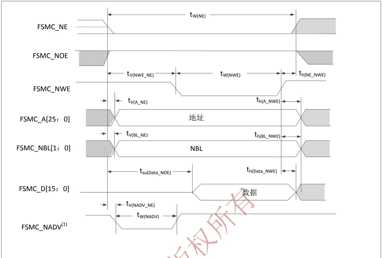
图 17 异步非总线复用的 SRAM/PSRAM/NOR 写操作波形
