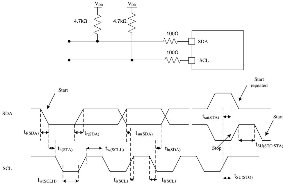
图 36 I<sup>2</sup>C 总线交流波形和测量电路<sup>(1)</sup>
