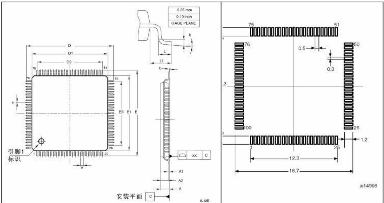
图 50LQFP100，100 脚低剖面方形扁平封装图
