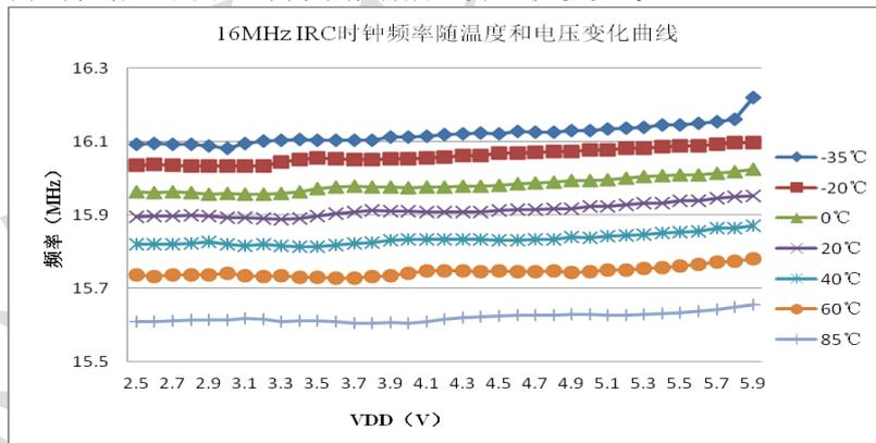
图16 16MHz RC 时钟频率的电压和温度特性
