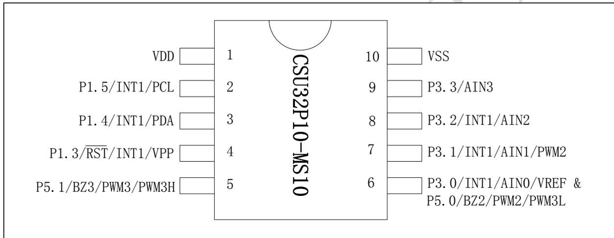
注：PT3.0 和 PT5.0 是封装在一个 PIN 脚，使用 PT3.0 口功能，通过程序把 PT5.0 配置为数字输入口；使用 PT5.0 口功能，通过程序把 PT3.0 配置为数字输入口。
