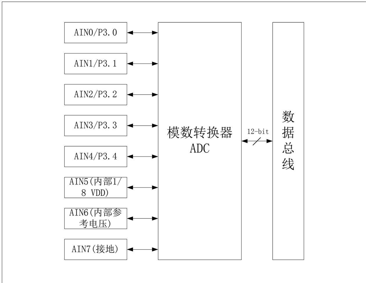
图14 模数转换器 ADC 功能框图
