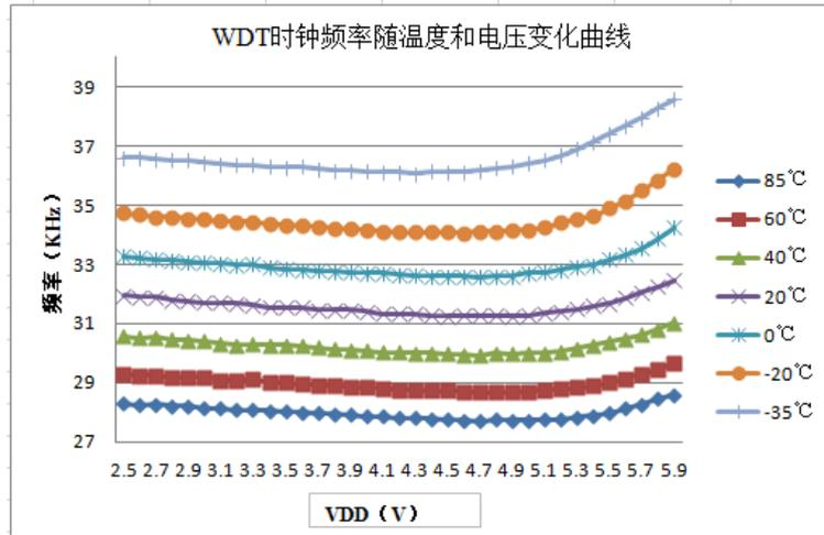
图17 WDT 频率的电压和温度特性
