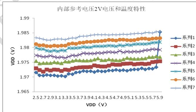
图22 内置参考电压 2.0V 电压和温度特性
