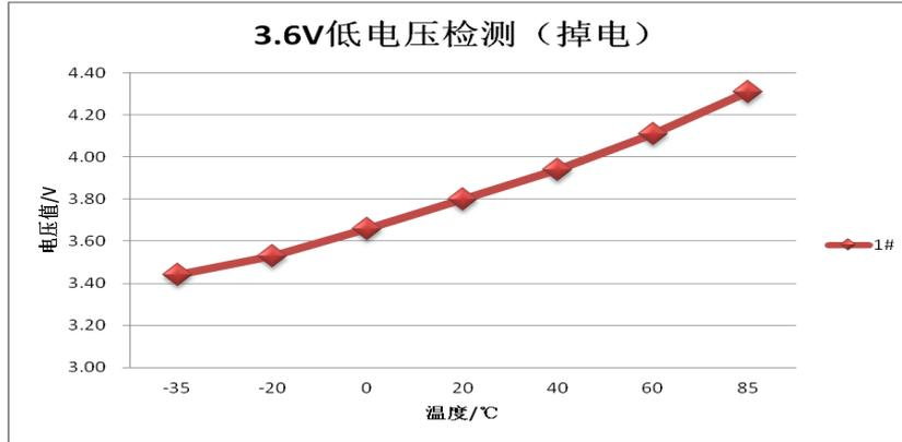
图20 3.6V 低电压复位温度特性
