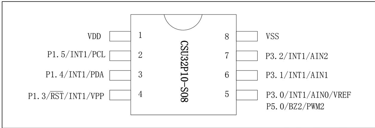
注：PT3.0 和 PT5.0 是封装在一个 PIN 脚，使用 PT3.0 口功能，通过程序把 PT5.0 配置为数字输入口；使用 PT5.0 口功能，通过程序把 PT3.0 配置为数字输入口。
