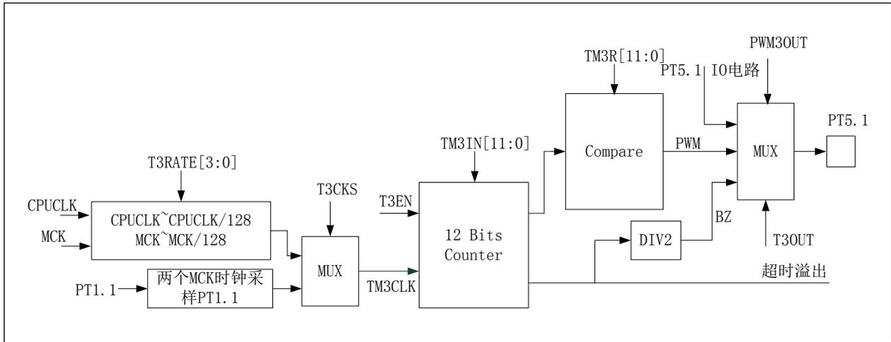
图12 定时/计数器 3 模块的功能框图
