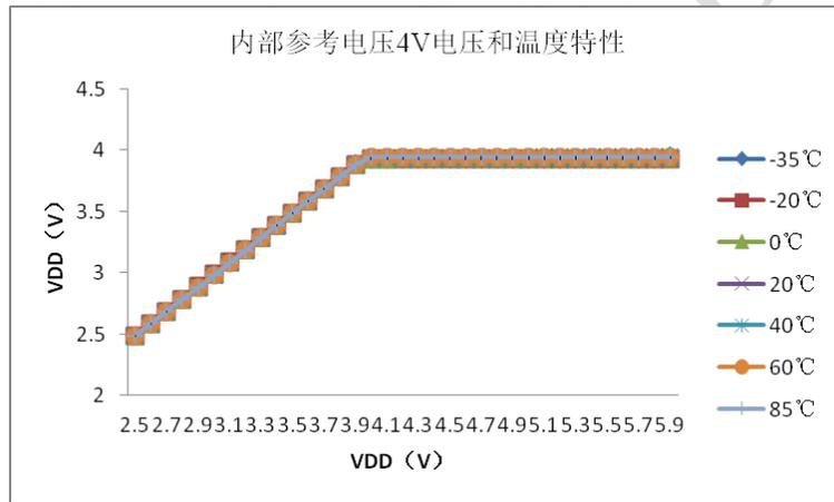
图24内置参考电压 4.0V 电压和温度特性封装图
