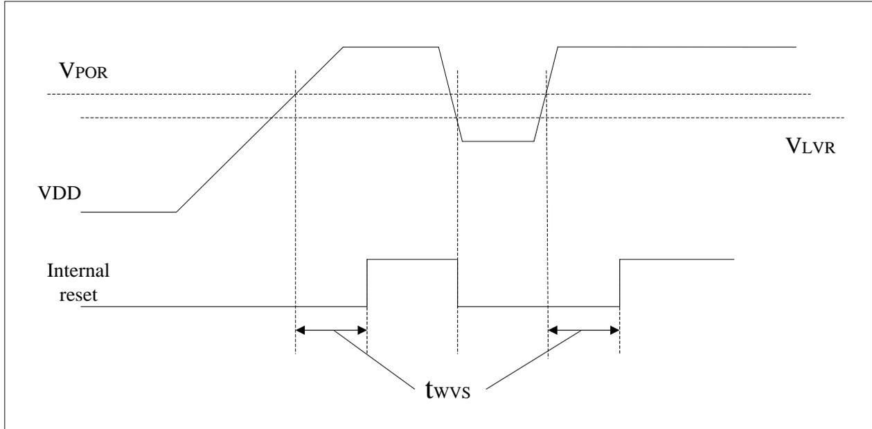
图6 上电复位电路示例及上电过程
