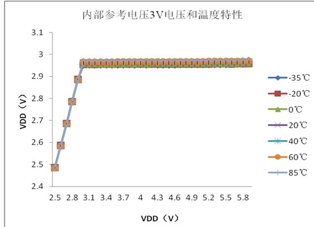
图23 内置参考电压 3.0V 电压和温度特性
