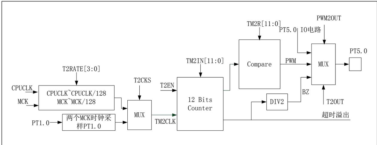
图11 定时/计数器 2 模块的功能框图
