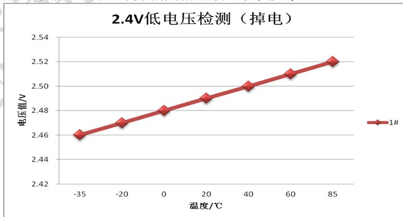
图19 2.4V 低电压复位温度特性
