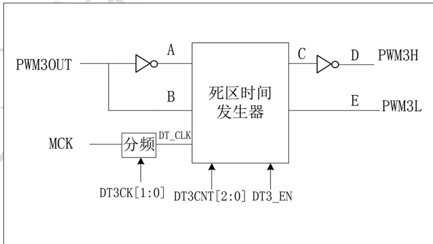
图13 互补式 PWM 输出方框图
