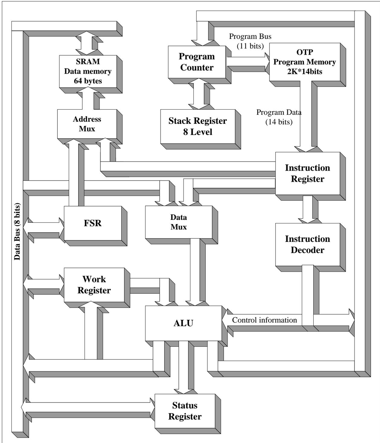
图1 CSU32P10 CPU 核的功能模块图
