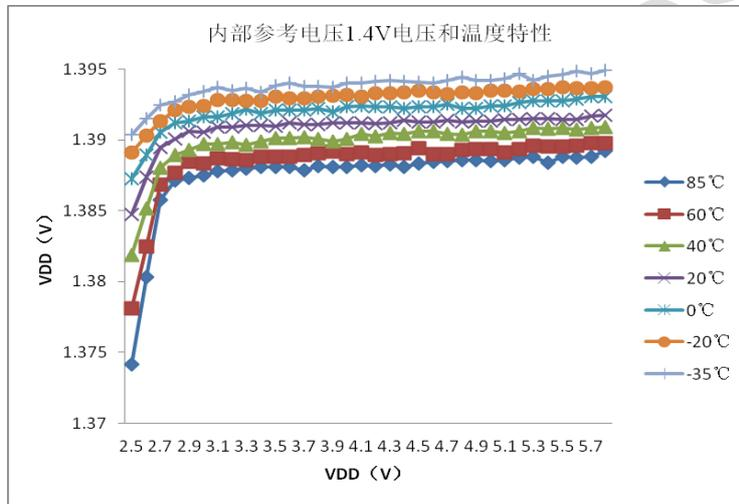
图21 内置参考电压 1.4V 电压和温度特性
