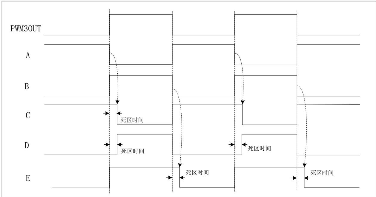
PWM 输出取反后的互补 PWM 输出
