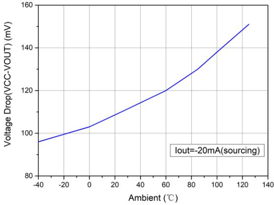
图 7-7  $V_{OH}$  VS. 温度 (20mA Load)
