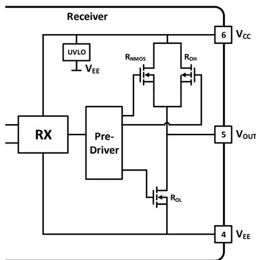
**图 9-2 输出级结构**
