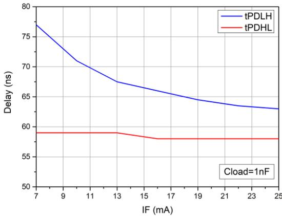
图 7-11 传输延时 VS. 输入正向电流
