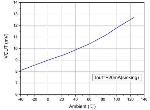
图 7-8  $V_{OL}$  VS. 温度 (20mA Load)
