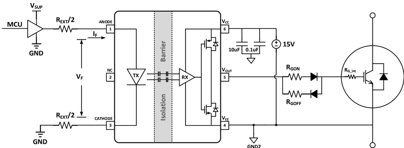
图 10-2 输入级使用缓冲器+电阻的典型应用
