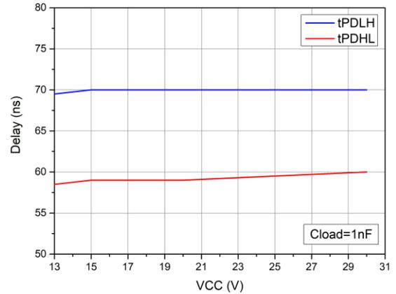
图 7-10 传输延时 VS. 供电电压
