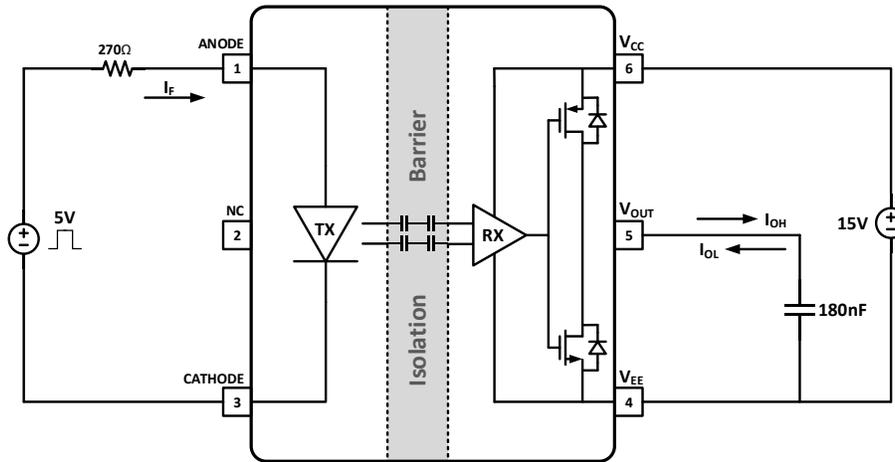
图 8-2  $I_{OH}$  和  $I_{OL}$  测试电路
