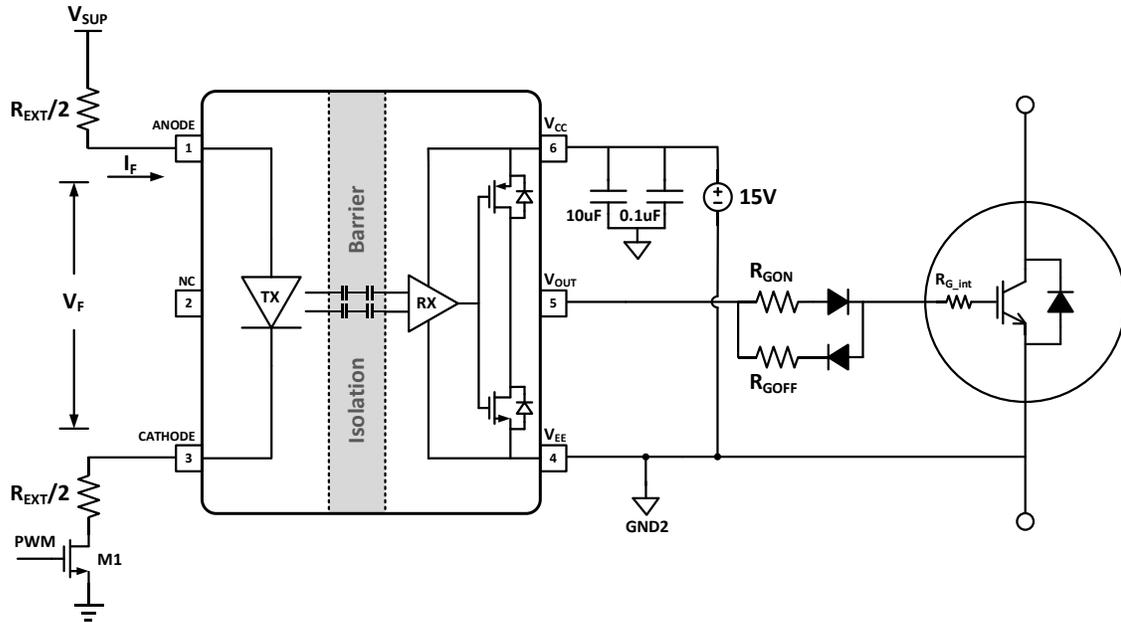
图 10-1 输入级使用 NMOS+电阻的典型应用
