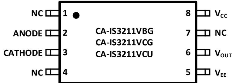
图 6-2 CA-IS3211VBG/ CA-IS3211VCG SOIC8-WB, CA-IS3211VCU DUB8 配置
