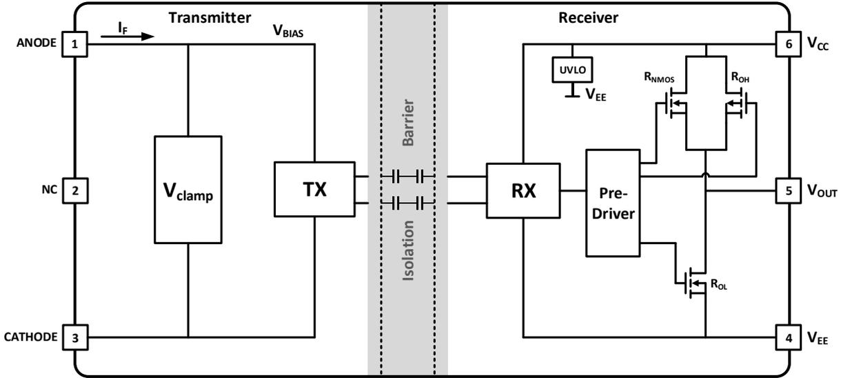
图 9-1 内部功能框图 (SOIC6-WB 封装)
