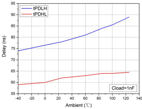
图 7-9 传输延时 VS. 温度
