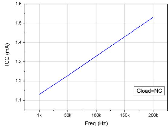
图 7-12 VCC 工作电流 VS. 频率
