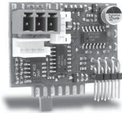
**Fig. 1.f****Analogue output module (code CONV0/10A0)**
