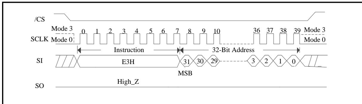
Figure 177. SPB Program (QPI Mode/3-Byte Address Mode)
