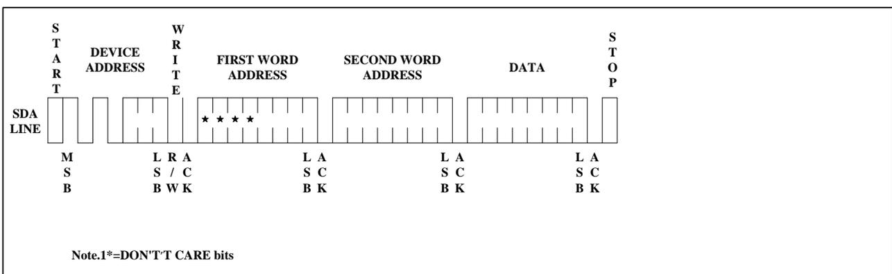
**Figure 6. Byte Write**
