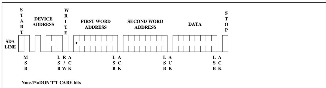
**Figure 6. Byte Write**
