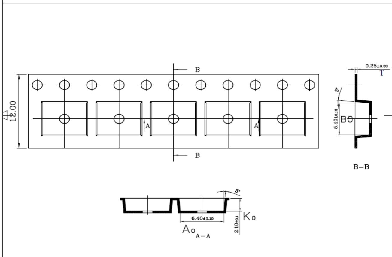
SOP 器件编带方向为 PIN 1 脚所对的圆点朝载带定位孔方向，如右图所示
