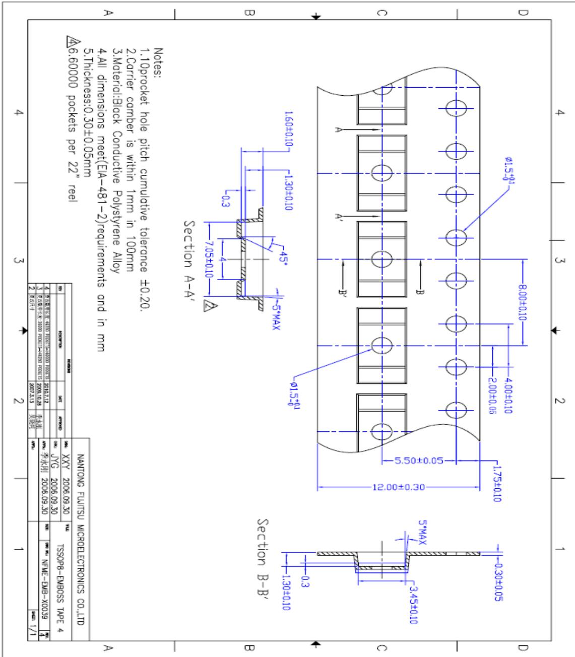
TSSOP 器件编带方向为 PIN 1 脚所对的圆点朝载带定位孔方向，如右图所示
