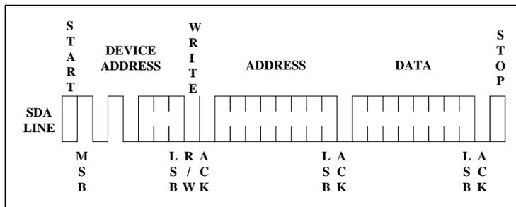
**Figure 7. Byte Write**
