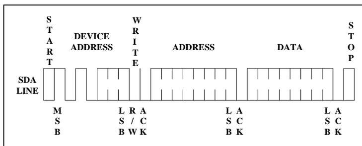
**Figure 7. Byte Write**
