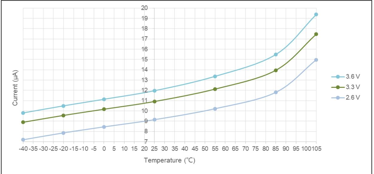
表 26. V<sub>BAT</sub> 的典型和最大电流消耗
