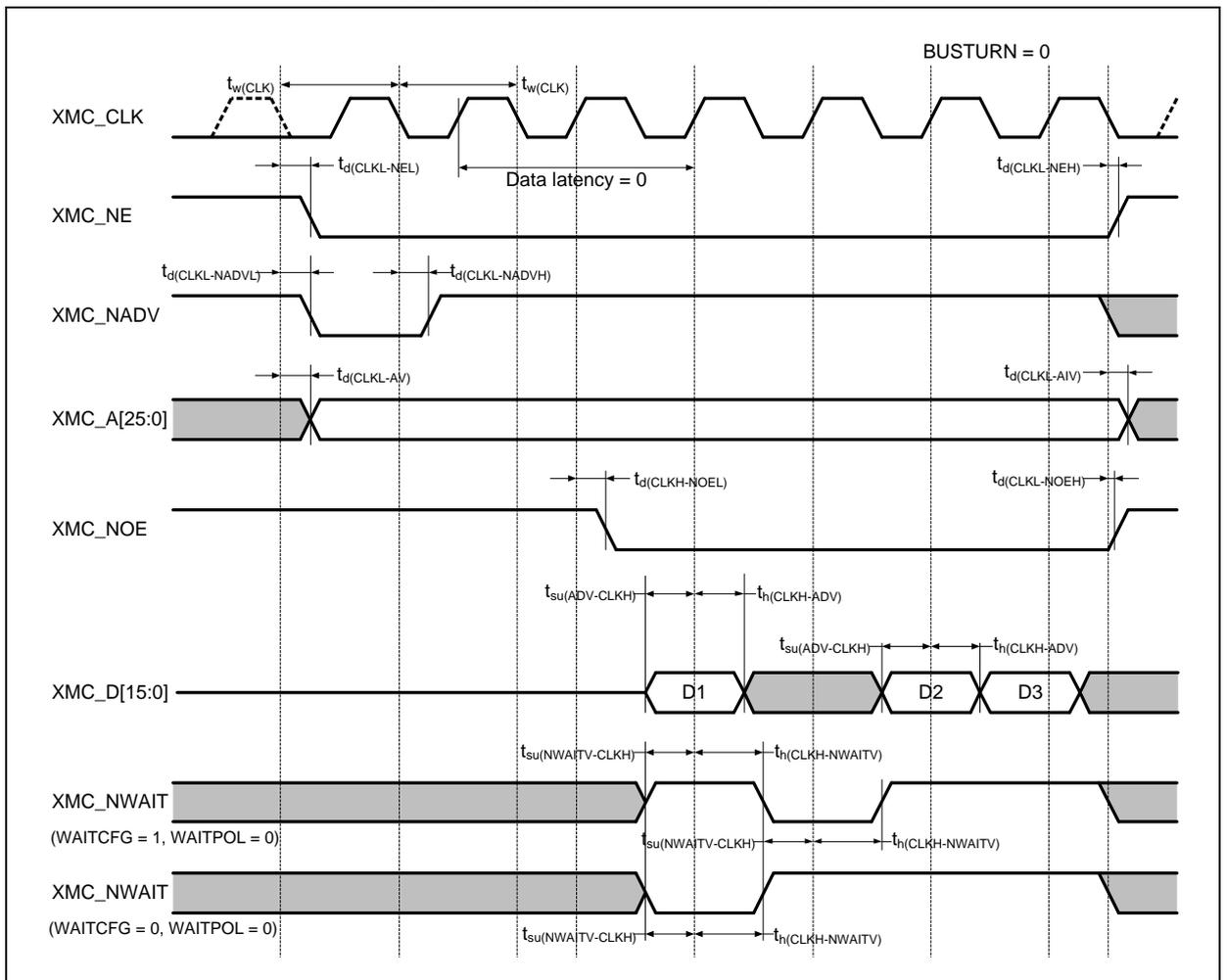
**表 46. 同步非总线复用 PSRAM 写操作时序**
