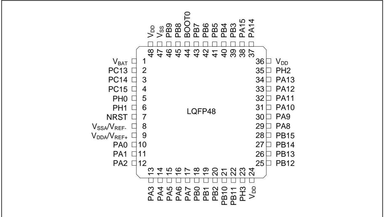
图 6. AT32F435 系列 QFN48 引脚分布
