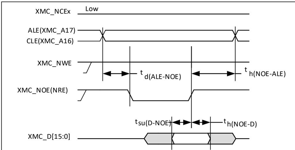
**图 29. NAND 控制器写操作波形**
