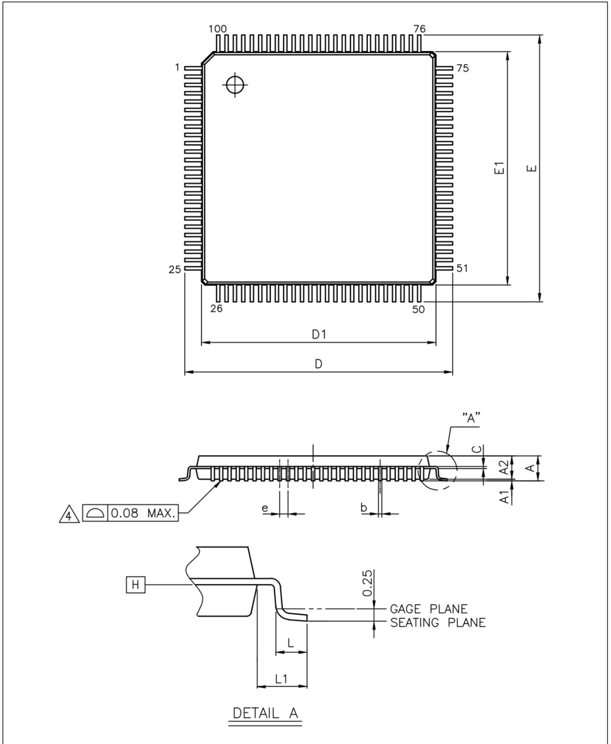
**表 72. LQFP100 – 14 x 14 mm 100 引脚薄型正方扁平封装机械数据**
