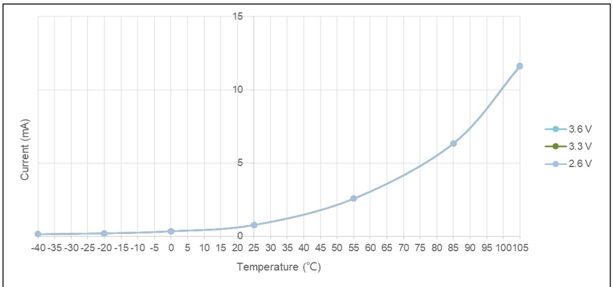
图 12. 待机模式下的典型电流消耗在不同的 V<sub>DD</sub> 时与温度的对比
