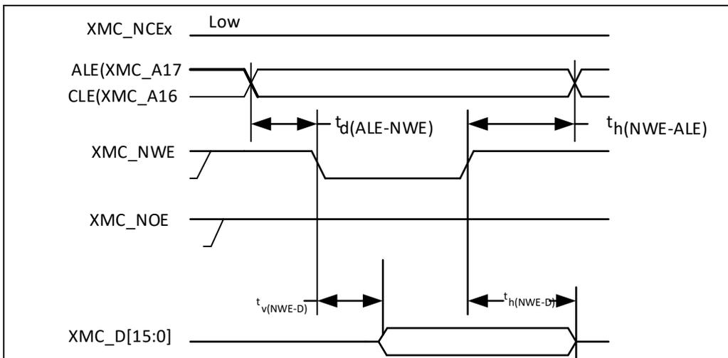
**图 30. NAND 控制器在通用存储空间的读操作波形**
