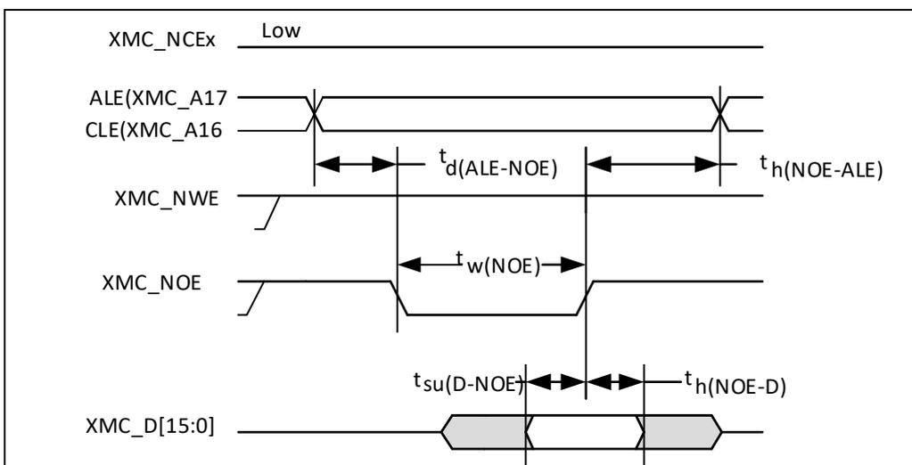
**图 31. NAND 控制器在通用存储空间的写操作波形**
