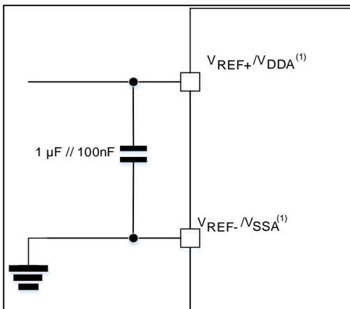
(1)  $V_{REF+}$ 输入只出现在100脚以上封装。
