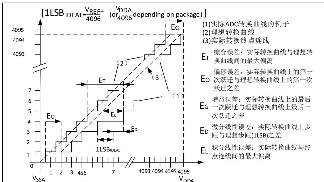
(1)实际ADC转换曲线的例子
