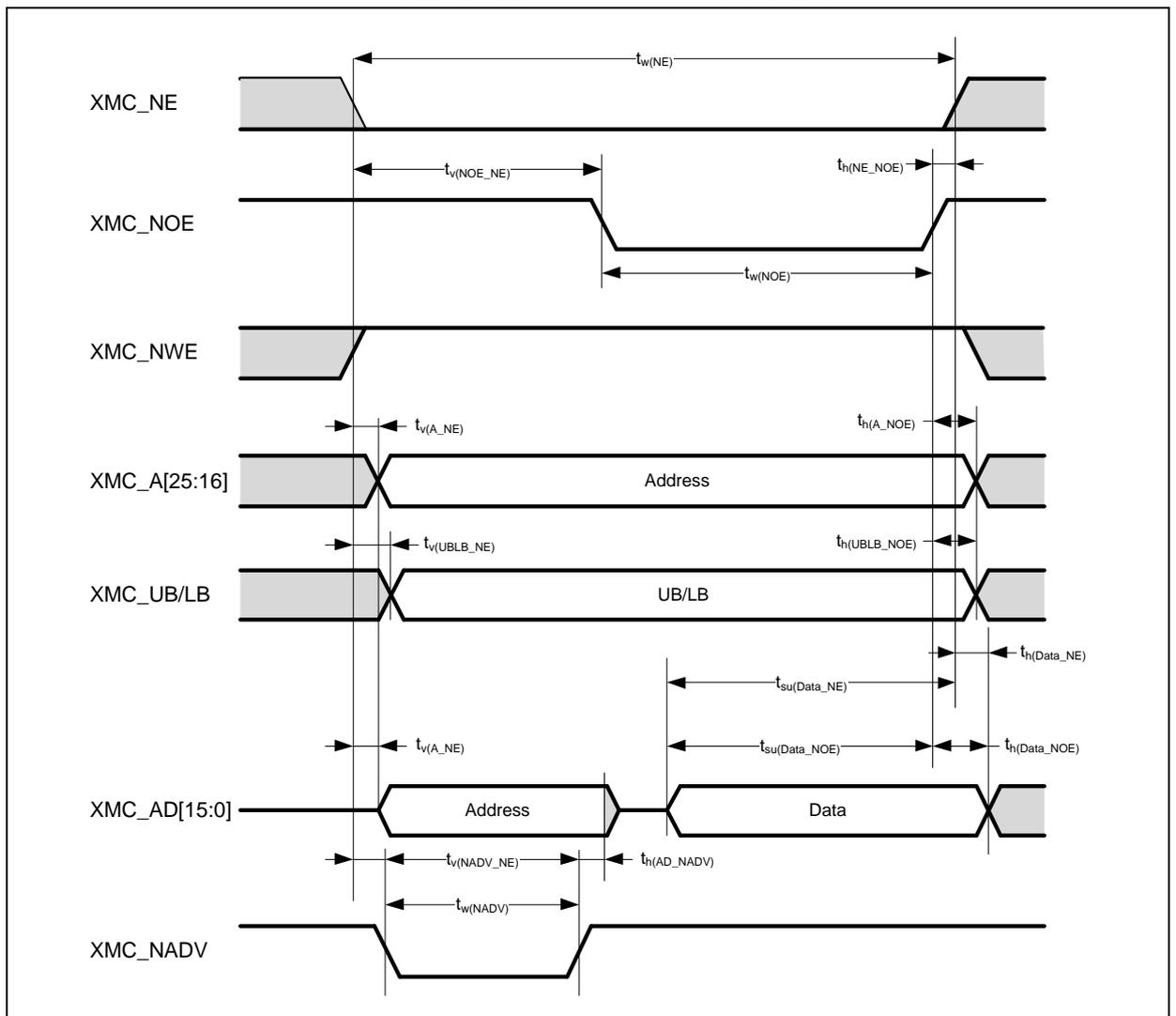
**表 44. 异步总线复用的 PSRAM/NOR 写操作时序**
