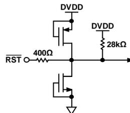
Figure 26.  $\overline{RST}$  Equivalent Circuit
