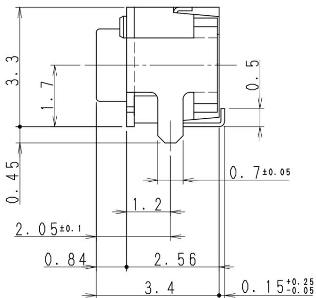
フ° リント基板取り付け寸法図
