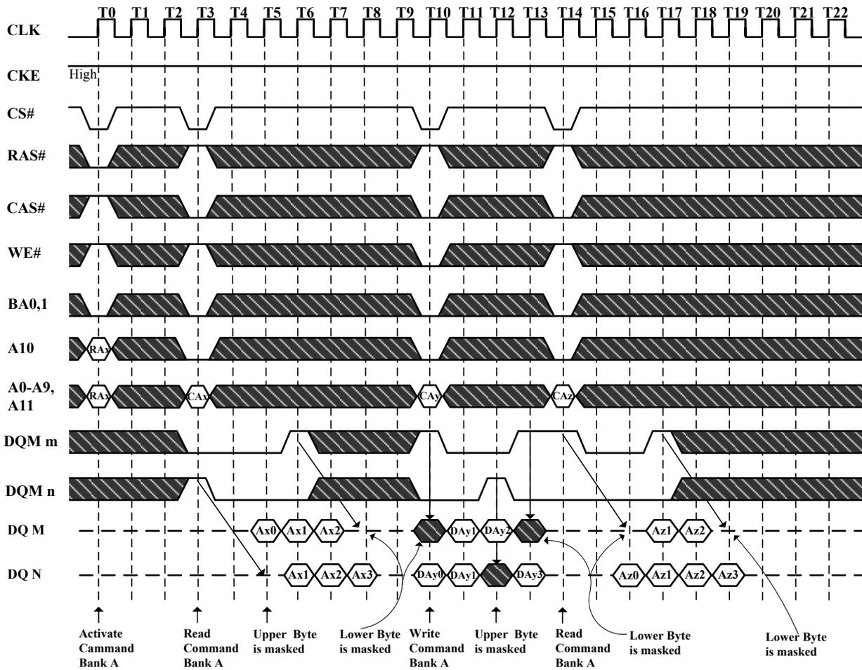
Note : M represent DQ in the byte m; N represent DQ in the byte n.
