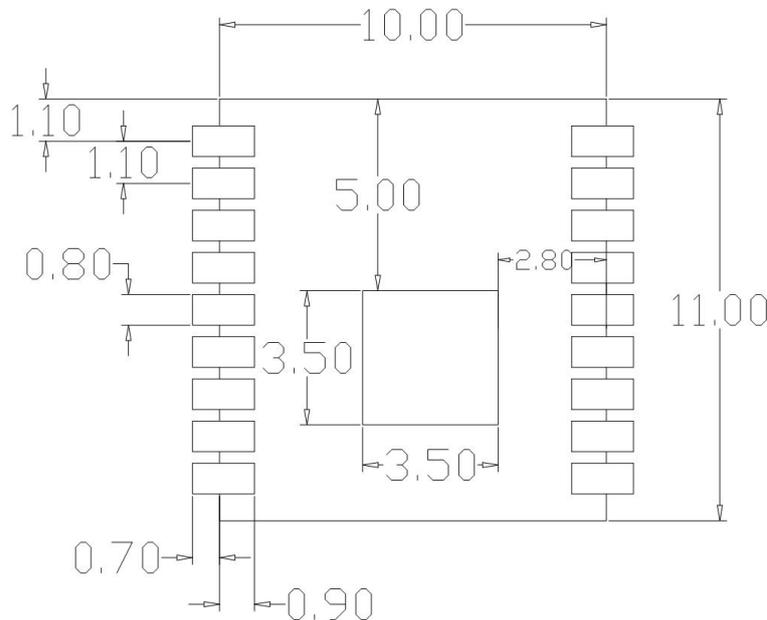
**注意：**此为 ESP-01F 模组封装图，推荐依照此图来设计 PCB 板，使模组能 PCB 板上正常工作；且设计焊盘时需注意，不能把 PCB 上的焊盘设计的比模组对应焊盘内缩偏移，而 PCB 焊盘相对模组焊盘外扩则不影响模组使用。
