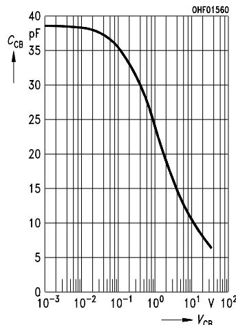
**Collector-Emitter Capacitance****Kollektor-Emitter Kapazität**
