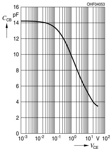
**Collector-Emitter Capacitance****Kollektor-Emitter Kapazität**
