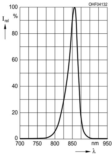
**Radiant Intensity** <sup>2) page 11</sup>**Strahlstärke** <sup>2) Seite 11</sup>
