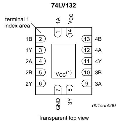
Fig 5. Pin configuration DHVQFN14
