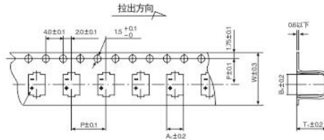
Fig. 2 (适用于 $D \geq \Phi 12.5\text{mm}$ 以上产品)
