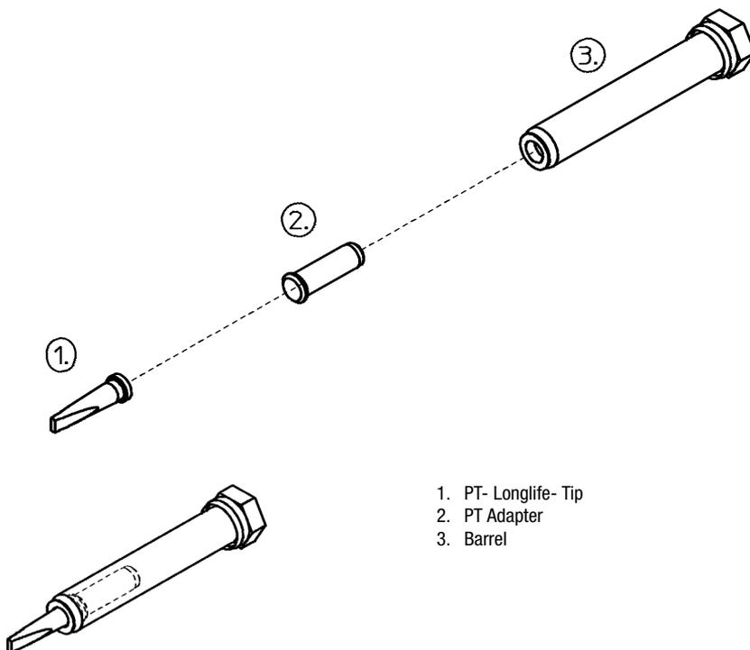
**Lötspitzen für TCP-Kolben (PT-Reihe)**
