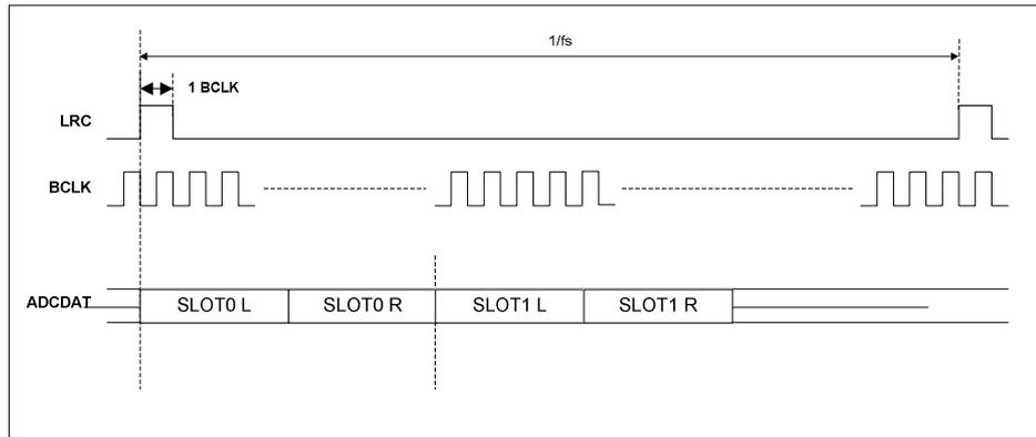
Figure 77 TDM in DSP Mode B
