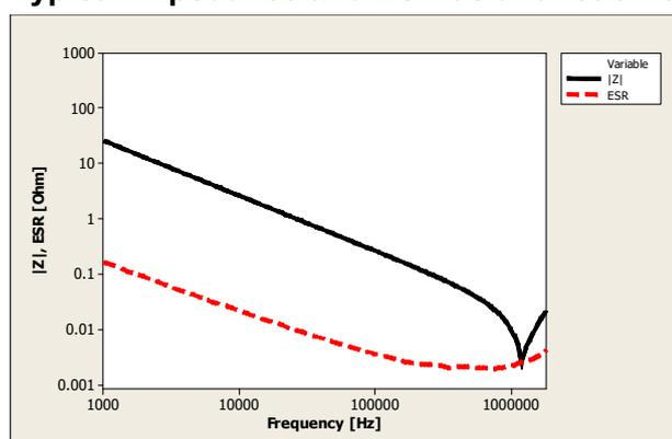
$V_{DC} = 0\text{ V}$ ,  $V_{AC} = 0.5\text{ }V_{RMS}$ ,  $T_{device} = +25\text{ }^{\circ}\text{C}$
