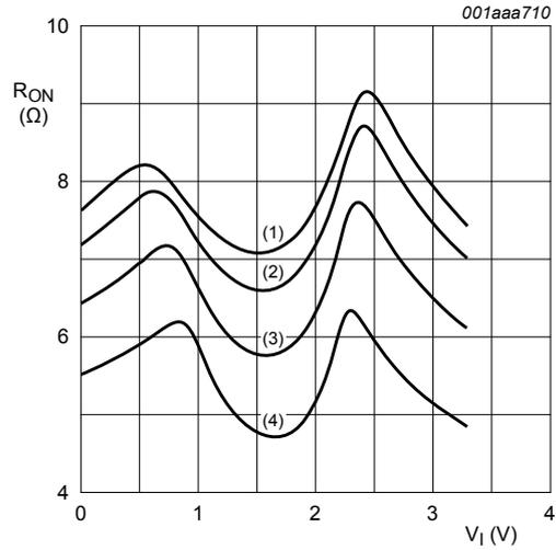
1. (1)  $T_{amb} = 125\text{ }^{\circ}\text{C}$
