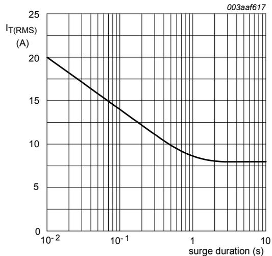
$f = 50\text{ Hz}$ ;  $T_{mb} = 102\text{ °C}$
