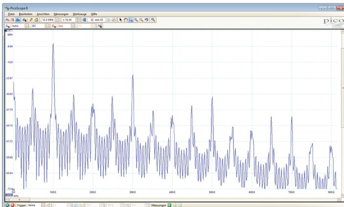
Per einfachem Mausklick können Sie ein neues Fenster öffnen, in dem eine spektrale Darstellung der ausgewählten Kanäle bis zur vollen Bandbreite der Oszilloskope angezeigt wird. Über vielfältige Einstellungen können Sie die Anzahl von Spektralbändern festlegen, Fensterarten wählen und Anzeigemodi steuern.
