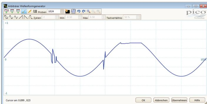
Ein Funktionsgenerator mit Sinus-, Rechteck-, Dreieck-, Gleichstromstufe- und vielen weiteren Standardwellenformen gehört ebenfalls zur Standardausstattung. Neben den Steuerungen zur Einstellung von Stufe, Offset und Frequenz ermöglichen es Ihnen erweiterte Optionen, bestimmte Frequenzbereiche abzutasten. In Verbindung mit der Speicherfunktion für Spektrum-Peaks verfügen Sie damit über ein leistungsstarkes Werkzeug zum Prüfen der Reaktion von Verstärkern und Filtern.
