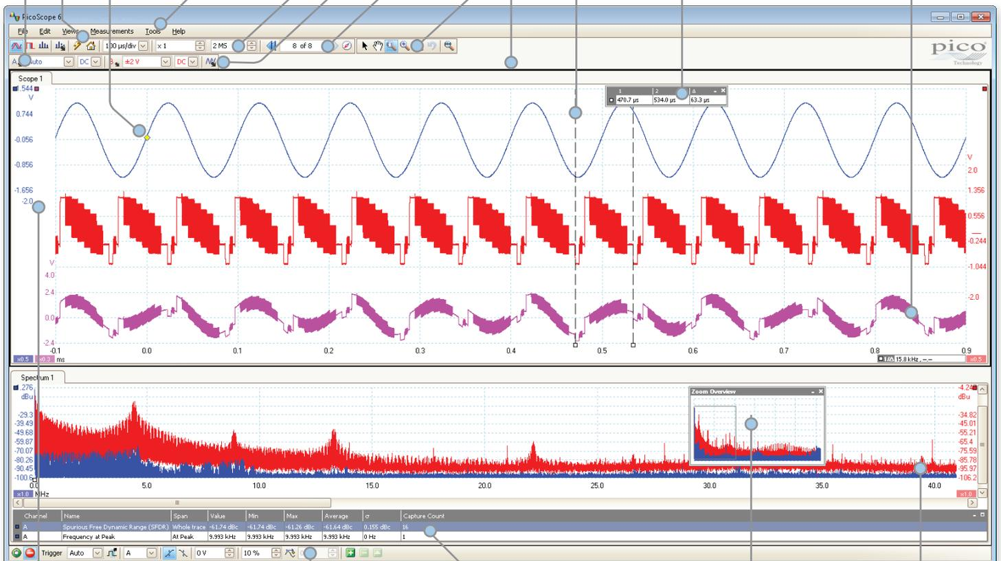
**Verschiebbare Achsen:** Die vertikalen Achsen können nach oben und nach unten gezogen werden. Diese Funktion ist besonders nützlich, wenn eine Wellenform eine andere verdeckt. Zusätzlich ist ein Befehl zum automatischen Anordnen von Achsen verfügbar.
