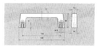
Einschließlich Schrauben DIN 84-M5  $\times$  12 und Scheiben DIN 125. Including screws DIN 84-M5  $\times$  12 and washers DIN 125.
