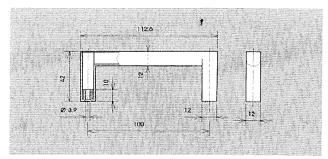
Einschließlich Schrauben DIN 84-M3,5 x 20, Scheiben DIN 125 und Muttern DIN 934-M3,5.
