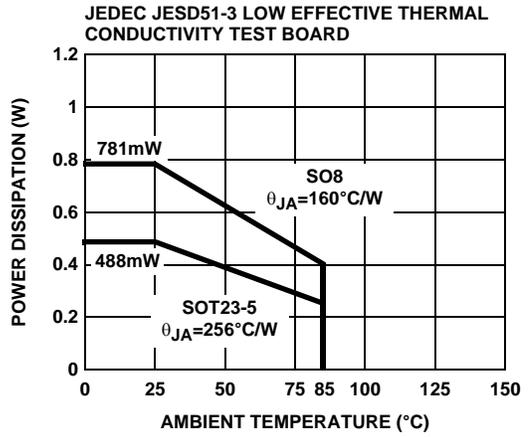
FIGURE 48. PACKAGE POWER DISSIPATION vs AMBIENT TEMPERATURE
