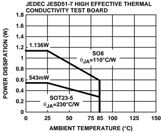
FIGURE 49. PACKAGE POWER DISSIPATION vs AMBIENT TEMPERATURE
