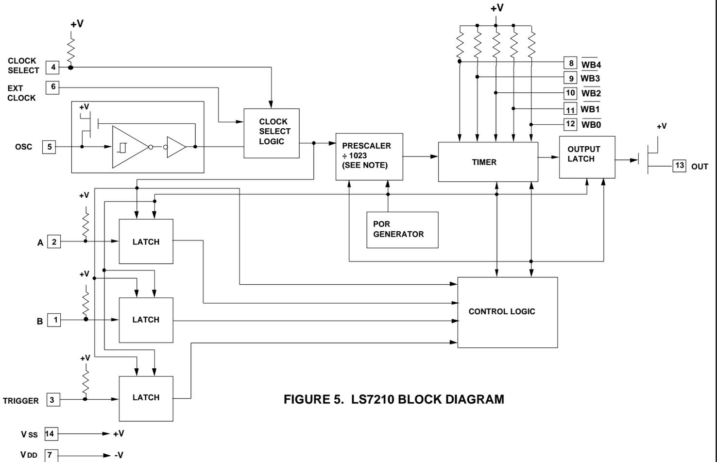
**FIGURE 5. LS7210 BLOCK DIAGRAM**
