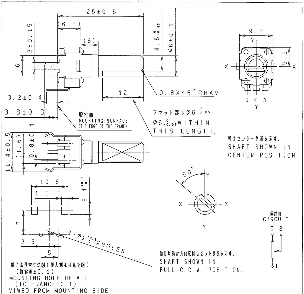
端子取付穴寸法図(挿入側より見た図)
