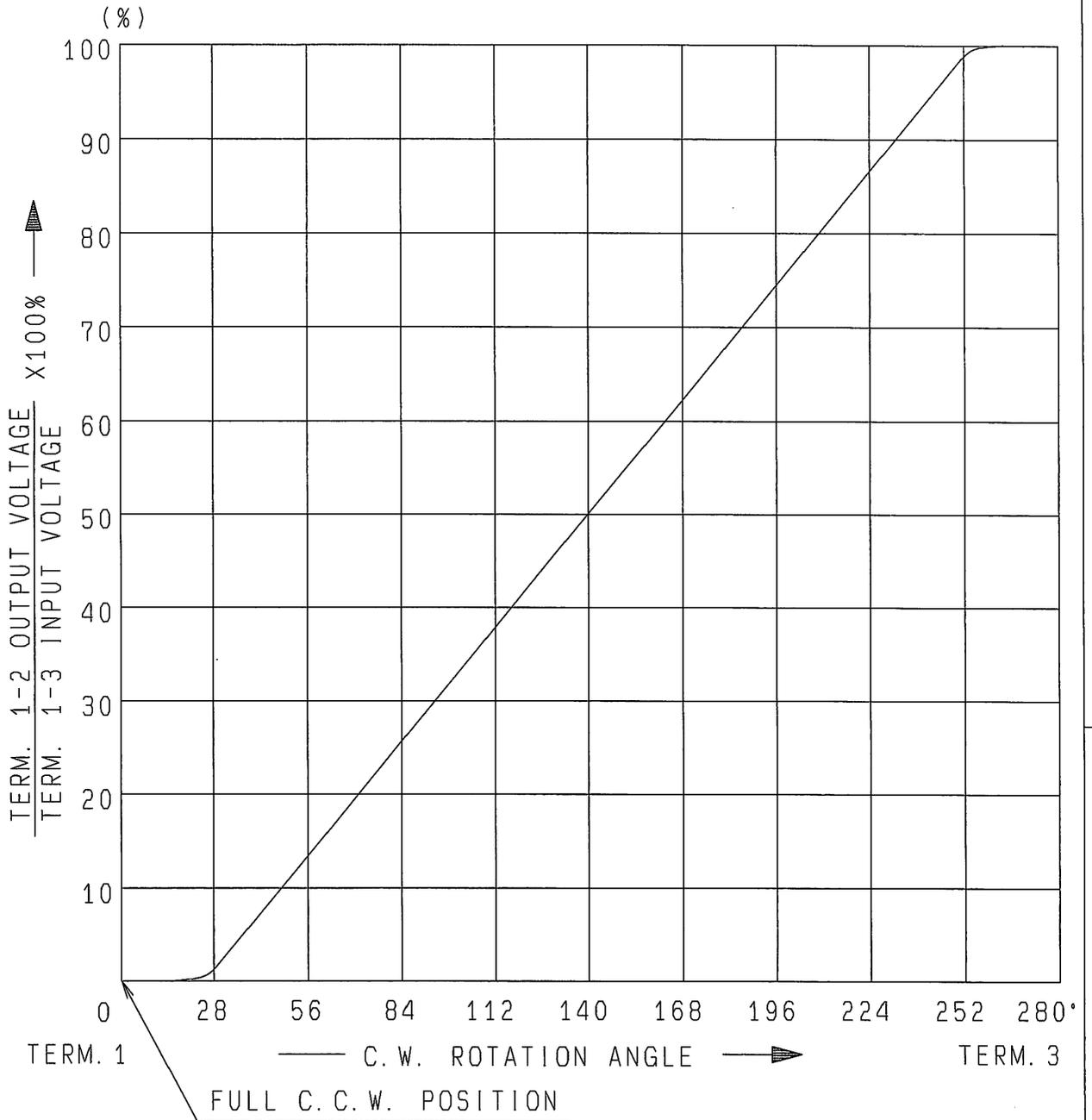
AT 140° C.W. SHAFT ROTATION FROM FULL C.C.W. POSITION VOLTAGE PERCENT SHALL FALL WITHIN THE LIMITS OF 40~60 PERCENT.
