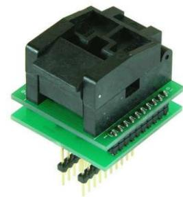
Die Umsetzung dieses Adapters ist 1:1 (Pin zu Pin). Der Adapter kann mit allen Programmiergeräten verwendet werden, insofern diese den gewünschten Chip auch unterstützen.
